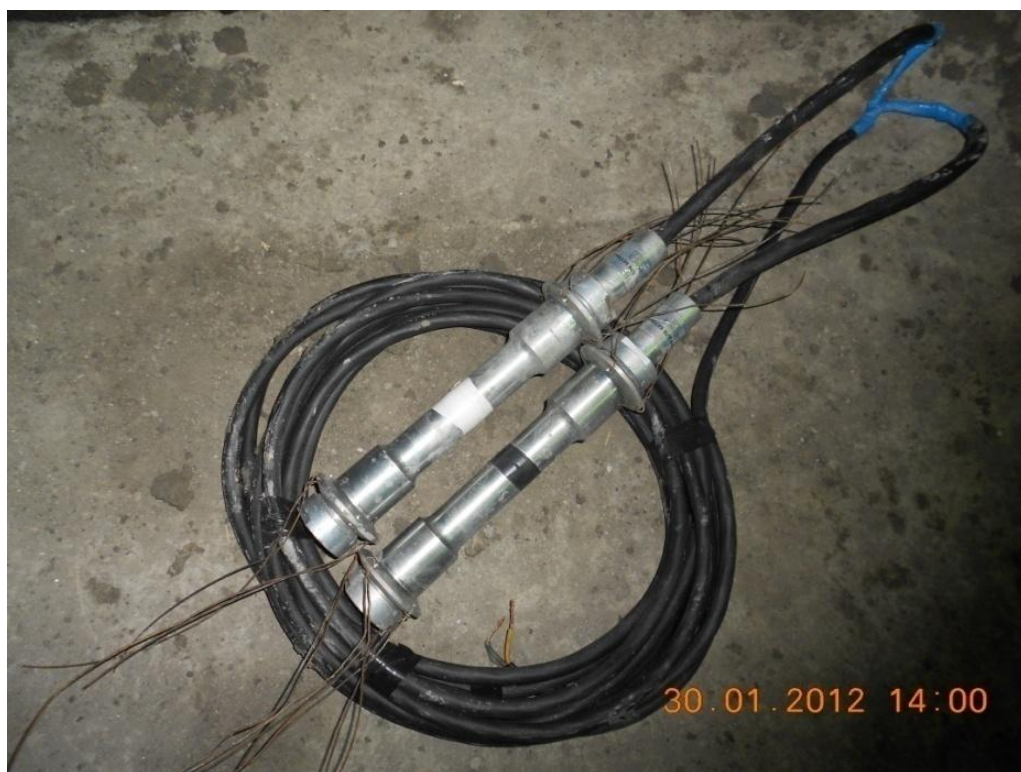
Рисунок 2.7. – Внешний вид готовых к установке струнных датчиков ТБ-200
