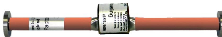
Замоноличиваемые тензометры работают по принципу стандартных струнных датчиков: возбуждение колебаний струны и «считывание» результата возбуждения (преобразование колебаний в электрический сигнал) осуществляется электромагнитной катушкой. Любое изменение натяжения струны приводит к изменению ее собственной частоты колебания и прямо пропорционально значению деформации конструкции, за которой ведется наблюдение.
