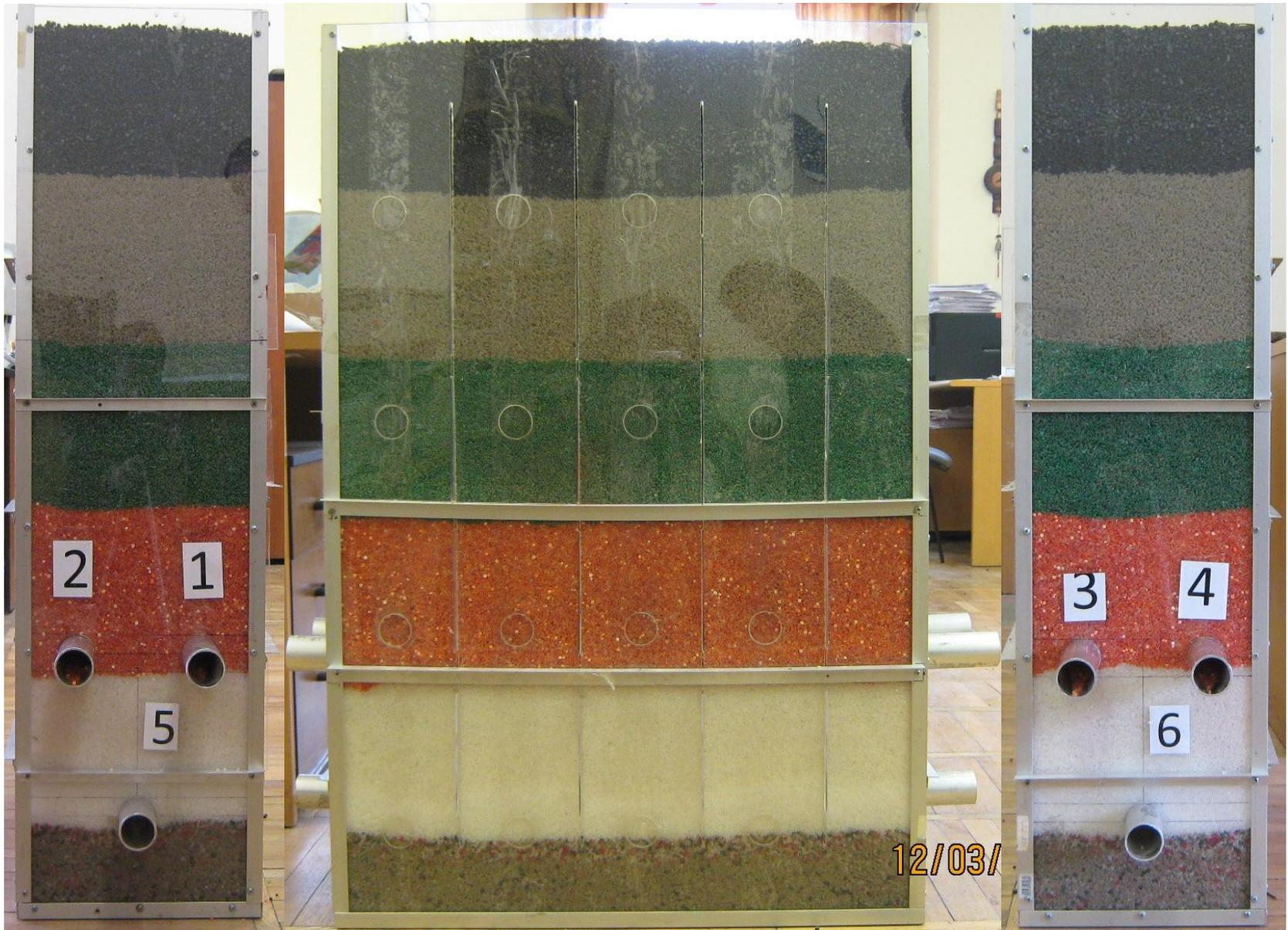
Рис.2.5. Физическая модель этажного торцевого выпуска рудной массы (общий вид)
