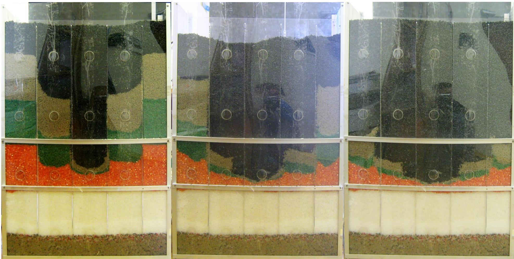
**Рис.2.13. Стадии выемки запасов секций физической модели**
