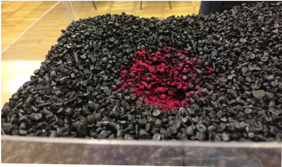
**Рис. 2.3. Образовавшаяся воронка прогиба на конец эксперимента**
