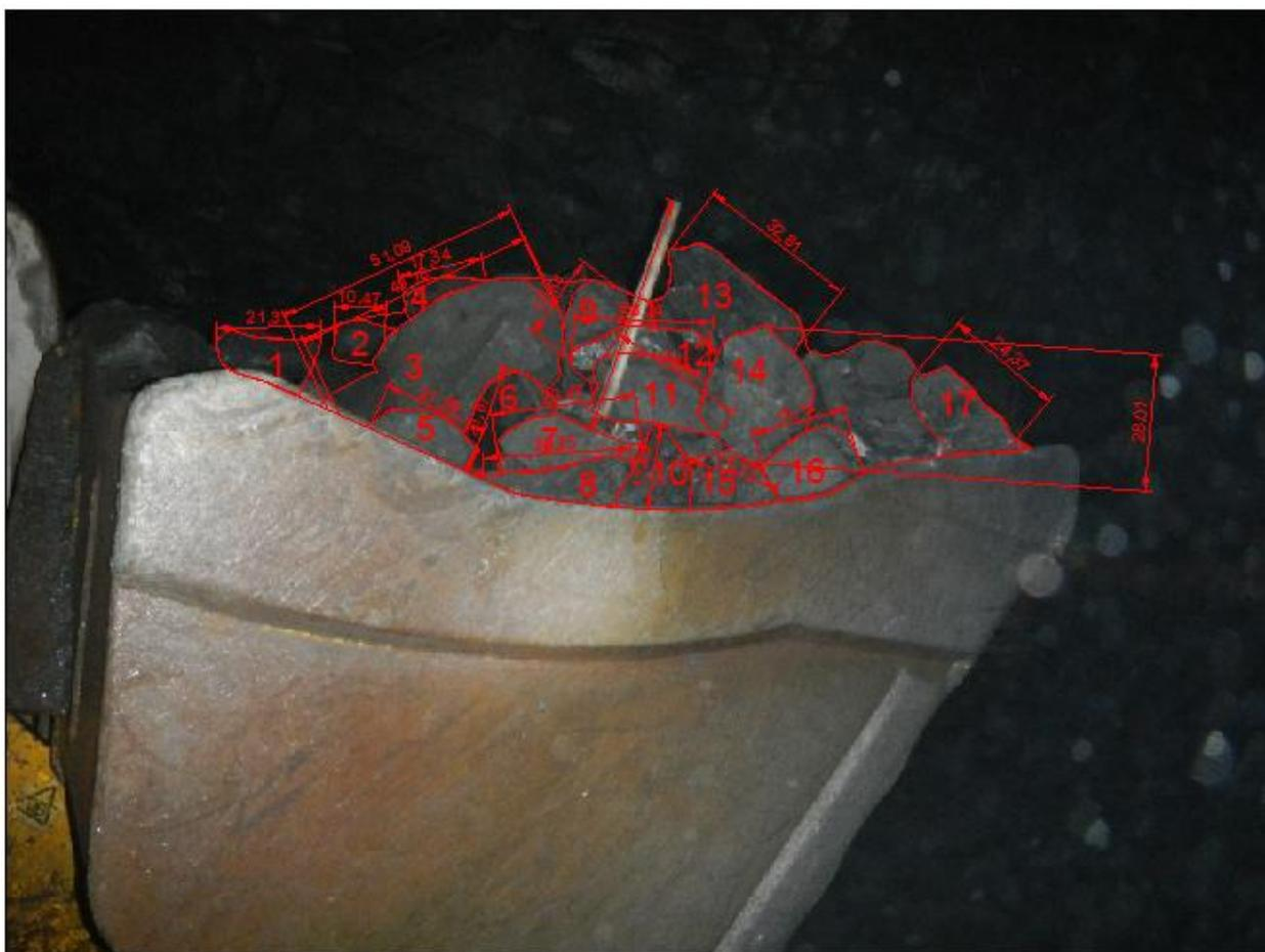
Рис.3.5. Контур рудной массы (фотоматериал рудника «Северный»)
