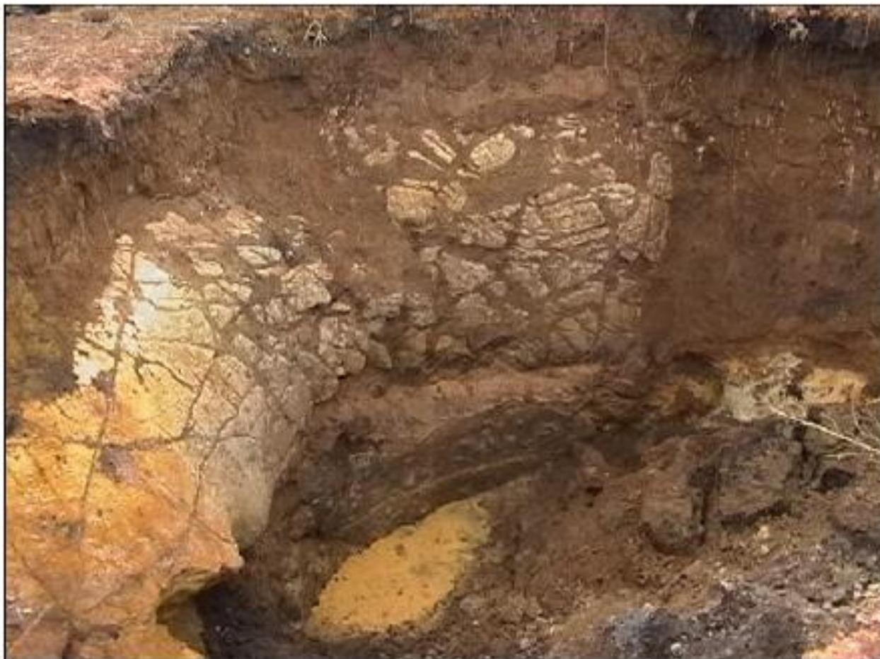
*Рис. 5.1* **Обнажение закарстованного массива как пример иерархической блочной структуры.**
