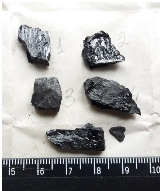
Рисунок 3.3 – Лабораторные пробы углей, подготовленные для исследования в сканирующим электронном микроскопе
