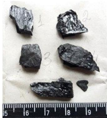
Рисунок 1 – Подготовленные для исследования с помощью сканирующего микроскопом лабораторные пробы углей
