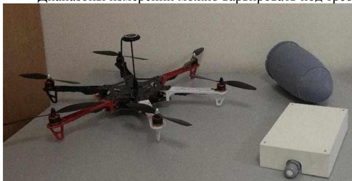
Рисунок 1 – Фотография пробоотборника воды и комбо-системы, используемых в динамике при помощи БПЛА
