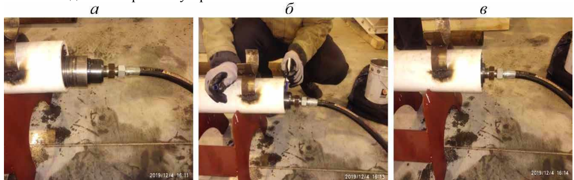
Рисунок 11 – Стендовые испытания пакера в трубе диаметром 105 мм
