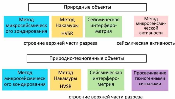
Рисунок 6 - Блок-схема комплекса сейсмических пассивных методов
