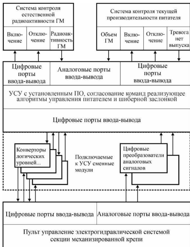
Рисунок 3 – Схема подключения оборудования контроля процесса выпуска подкровельной толщи к пульту управления с использованием УСУ
