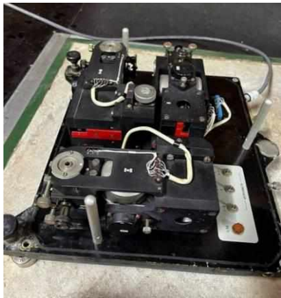
Рисунок 4 – Сейсмометр СМ-3КВ с расширенными характеристиками в 3-компонентном исполнении с открытой крышкой (слева) и плотность вероятности распределения спектральной плотности мощности микросейсмического шума вертикальной компоненты ускорения грунта (справа); черные линии – минимальный и максимальный уровень шума по [10]; красный – данные СМ-3КВ-кор, синий – данные широкополосного датчика: сплошная линия – статистическая мода, пунктир – 10 и 90 перцентили
