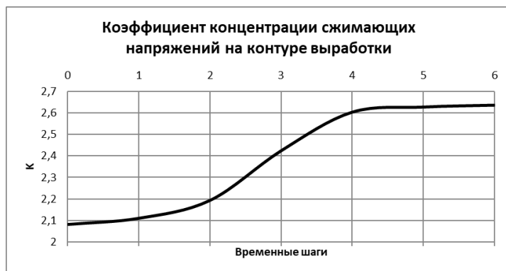
Рисунок 1 – Динамика изменения коэффициента концентрации сжимающих напряжений на контуре выработки
