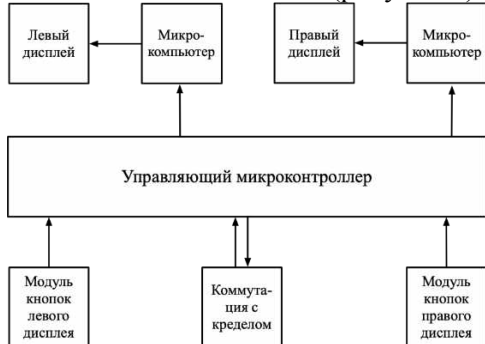
Рисунок 4 – Структурная схема устройства пульта управления и его внутреннее устройство
