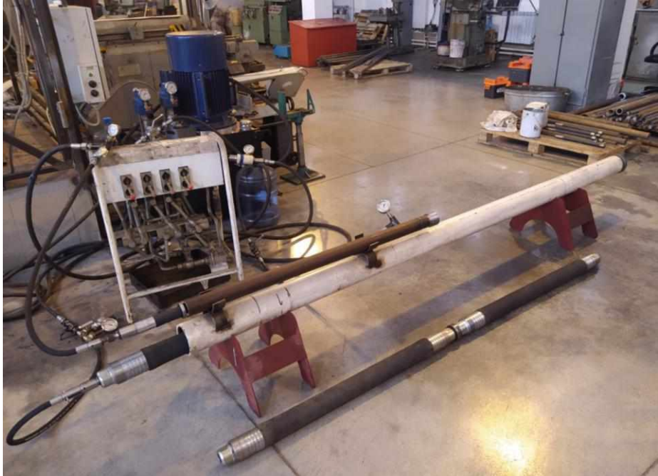
Рисунок 10 – Внешний вид стенда для испытания устройства работы клапана для разрыва горного массива
