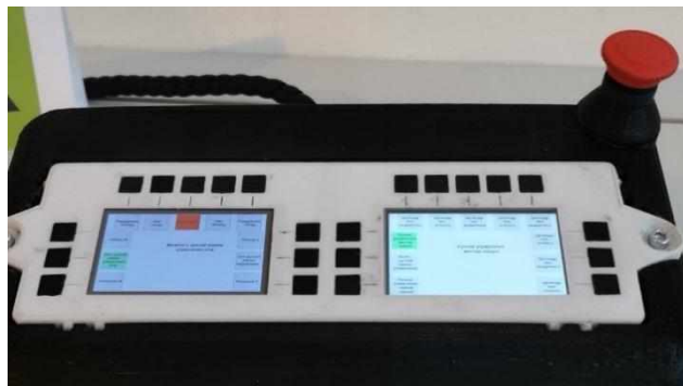
Рисунок 5 – Прототип пульта управления электро-гидрооборудованием
