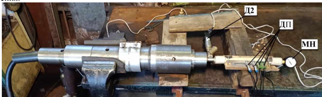
Рисунок 22 – Модель пневмоударной машины с регулируемой энергией ударных импульсов. D2 – датчик измерения давления в камере холостого хода; DP – датчики перемещения; MN – манометр
