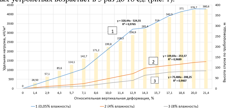
Рисунок 1. Зависимость удельной нагрузки компрессионного сжатия и высоты перепуска по трубопроводу от относительной вертикальной деформации сыпучих солеотходов при влажности (1–0,05%; 2–4%; 3–8%)
