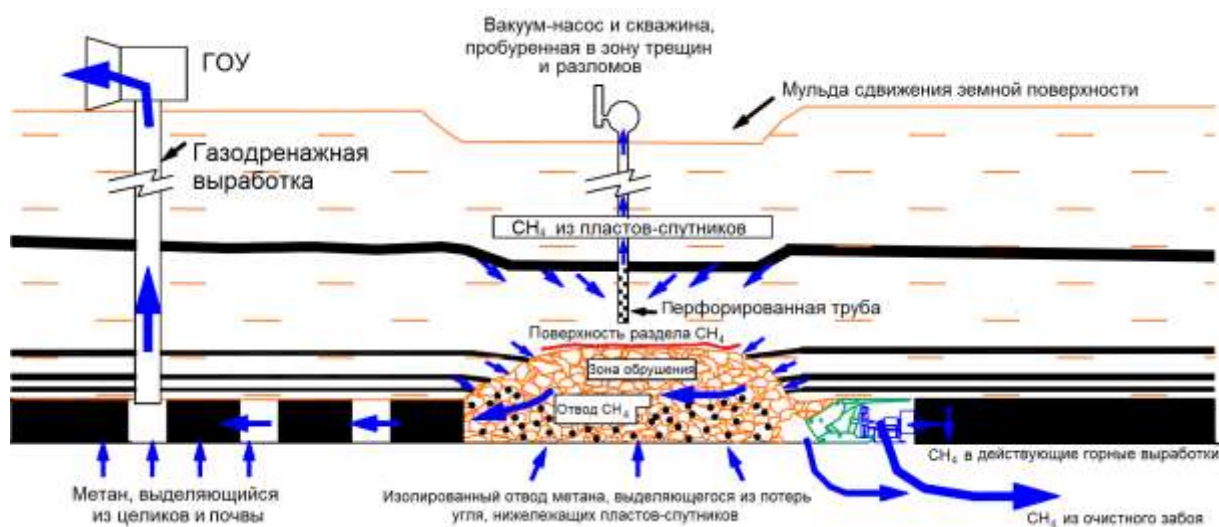
Рисунок 1.5 – Схема управления газовыделением на выемочном участке при высокоинтенсивной отработке пласта [340]
