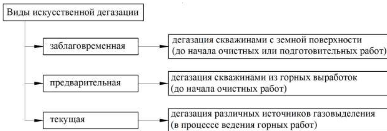
Рисунок 6.2 – Виды дегазации в зависимости от стадии разработки месторождений полезных ископаемых [4, 5, 286]
