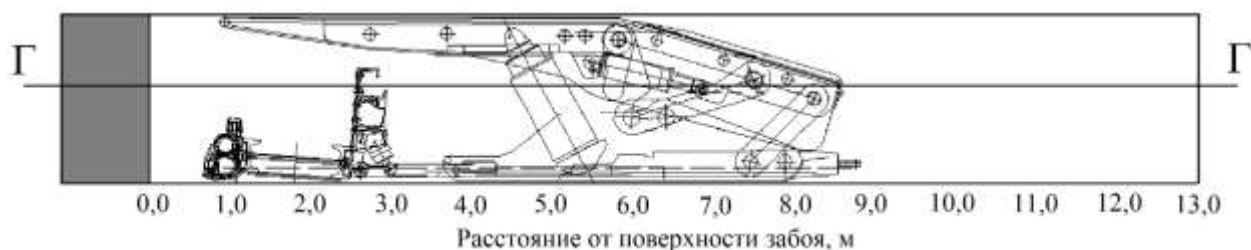
Рисунок 6.10 – Линия, вдоль которой приводится изменение скорости потока воздуха поперёк очистного забоя и закрепного пространства
