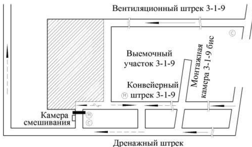
а, б, в – в/у 16-17, 1-1-5-6 бис и 3-1-9, соответственно С, М – обозначения размещения датчиков контроля в системе выработок (для скорости потока воздуха и концентрации метана) Рисунок 2.4 – Локация датчиков системы АГК на выемочных участках – объектах исследования (окончание)
