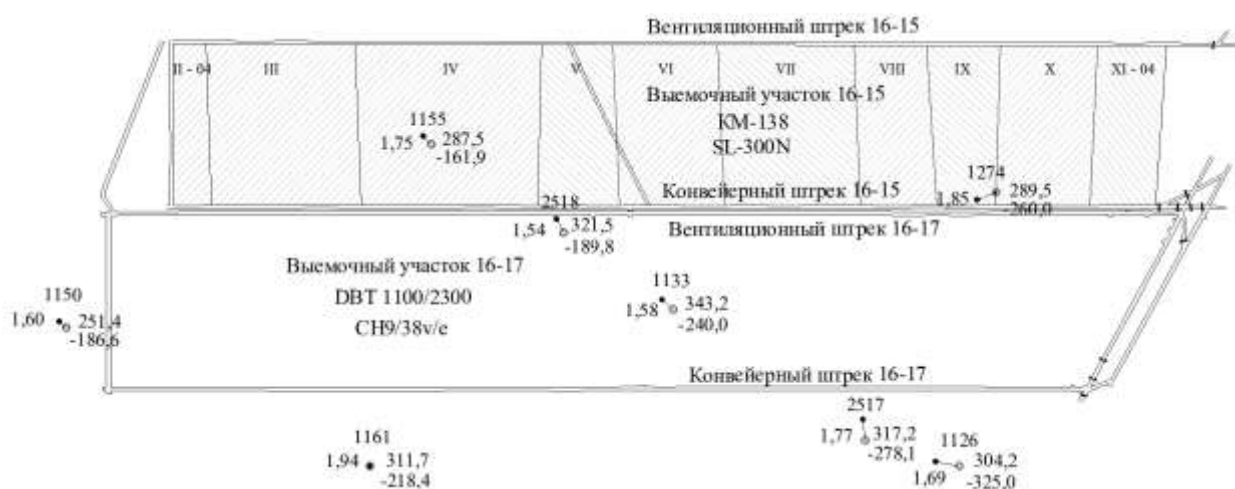
Рисунок 2.2 – Фрагмент плана горных выработок с в/у 16-17 (шахта «Абашевская») и указанием расположения разведочных скважин
