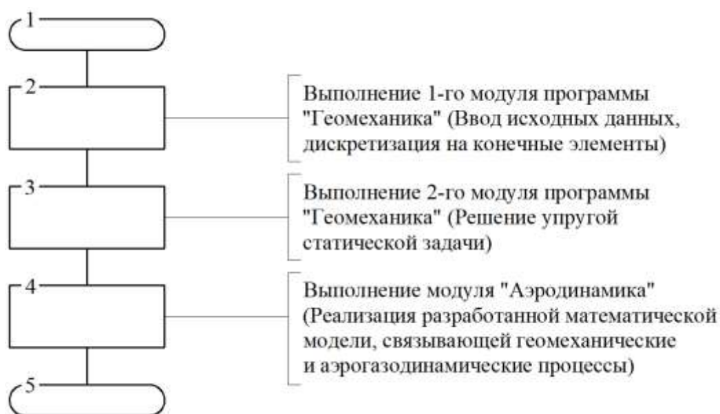
Рисунок 5.11 – Обобщённая блок-схема работы собранного пакета программ
