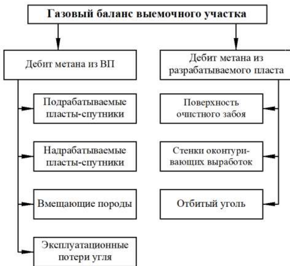
Рисунок 1.19 – Источники дебита метана на выемочном участке
