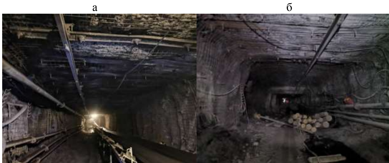
а – первая и б – вторая горные выработки Рисунок 3.7 – Горные выработки шахты «Увальная», закреплённые анкерной крепью
