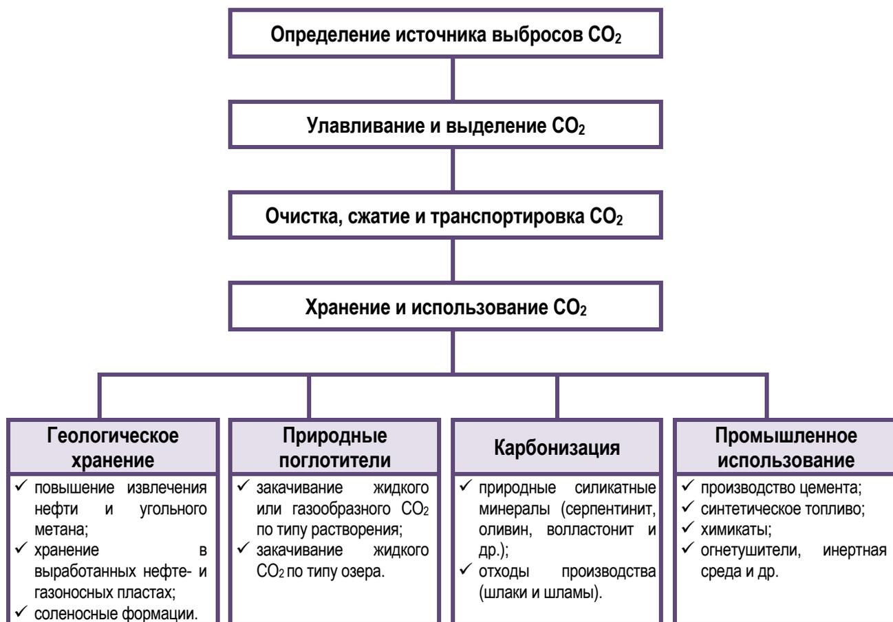
Рисунок 1.5 – Схема применения технологий улавливания, хранения и использования CO<sub>2</sub>
