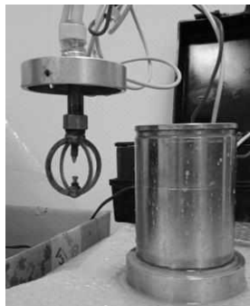
Рисунок 1 – Лабораторная установка для реализации электрогидравлической обработки
