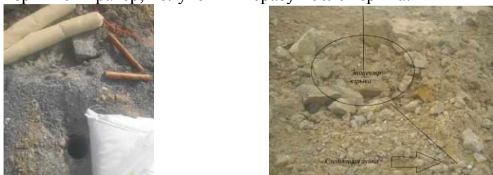
Рисунок 1 – Результаты полномасштабных экспериментов: компоненты взрывной смеси (до взрыва) и кратер (после взрыва)
