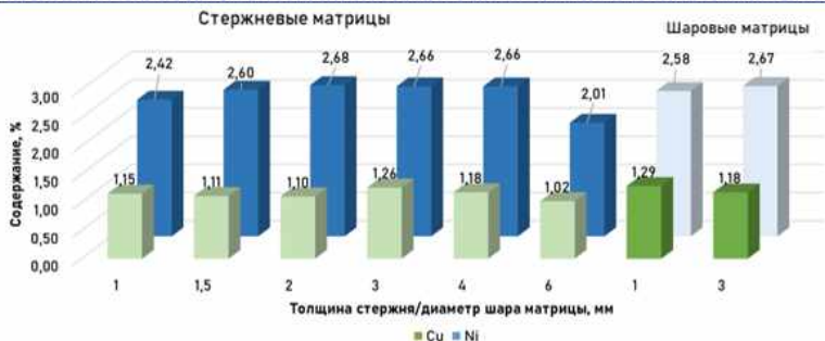
Рисунок - Результаты исследований по обогащению хвостов медно-никелевых руд по ключевым компонентам (Cu и Ni) после обогащения с применением ВГМС [составлено авторами]
