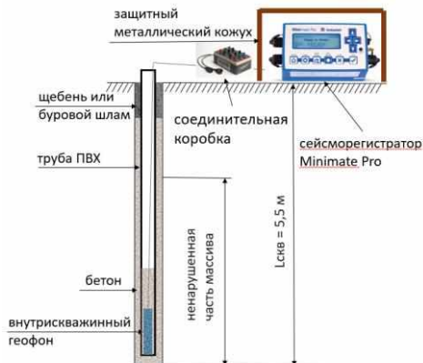
Рисунок 1 – Установка внутрискважинного геофона в скважину
