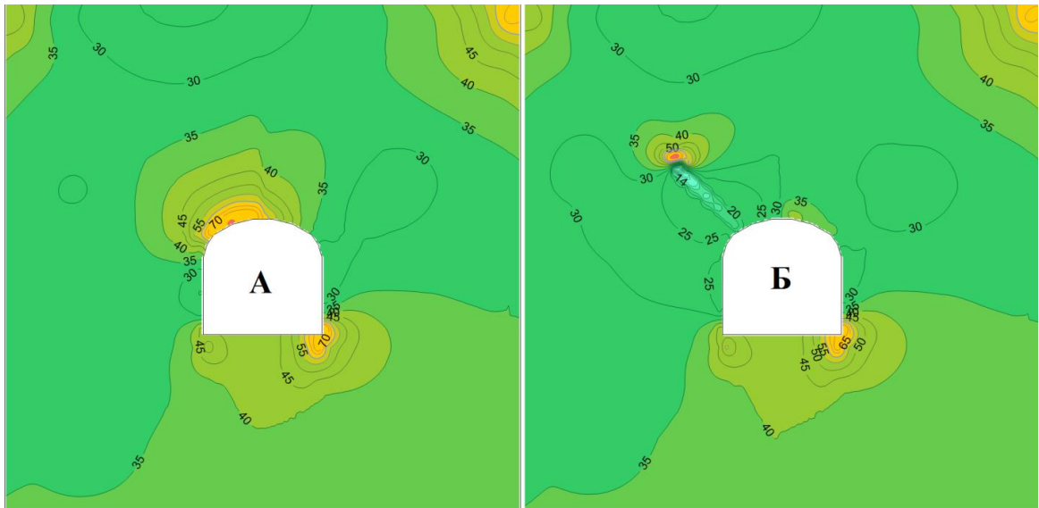
Рисунок 2.7 - Распределение полей максимальной компоненты напряжений. А - До моделирования структурной неоднородности, Б - после моделирования
