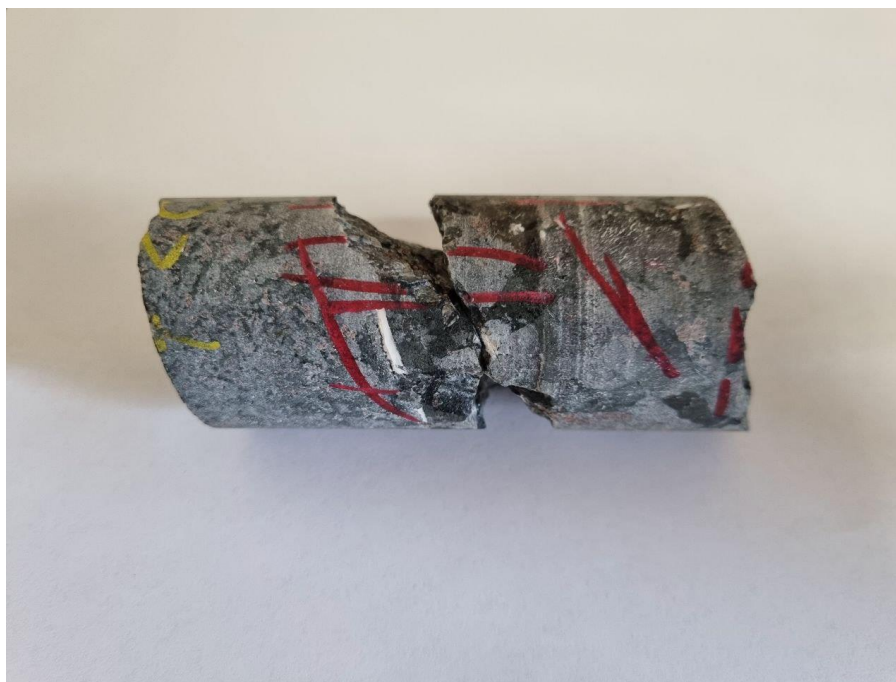
Рисунок 3.26 - Разрушение образца керна № 5 в результате проведения испытаний на сдвиг
