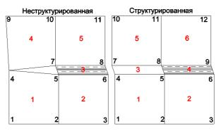
Рисунок 7 - Фиктивный элемент в структурированной сетке
