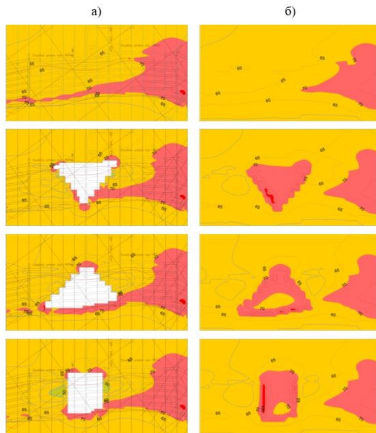
Рисунок 4.13 – Распределение  $\sigma_{max}$  при различных вариантах опережений
