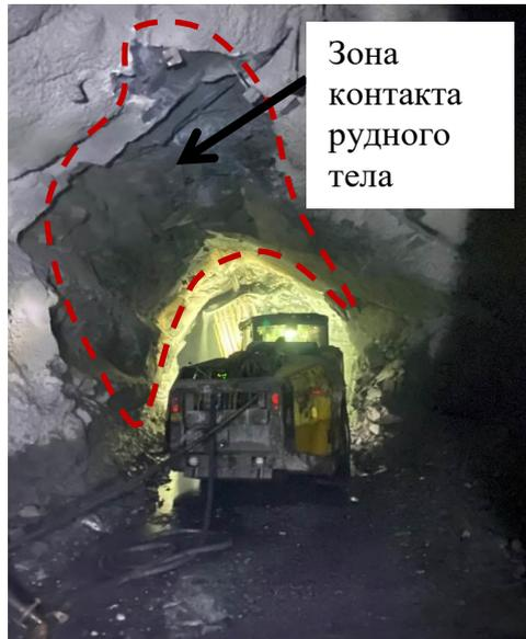
Рисунок 3.2 - Разрушение области контакта рудного тела и вмещающих пород в выработке штрекового направления
