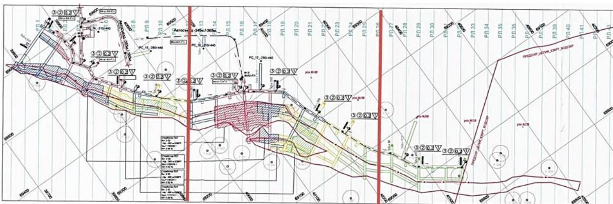
Рисунок 4.6 – План подэтажа -365 м как пример сложной горнотехнической ситуации с формированием целиков между фронтами горных работ (в разрезах 11-14) и безрудного целика, сформированного ветвлением рудного тела (в разрезах 17-20)
