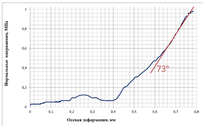
Рисунок 3.7 - Этап №1. Нормальная нагрузка: 1.0 МПа
