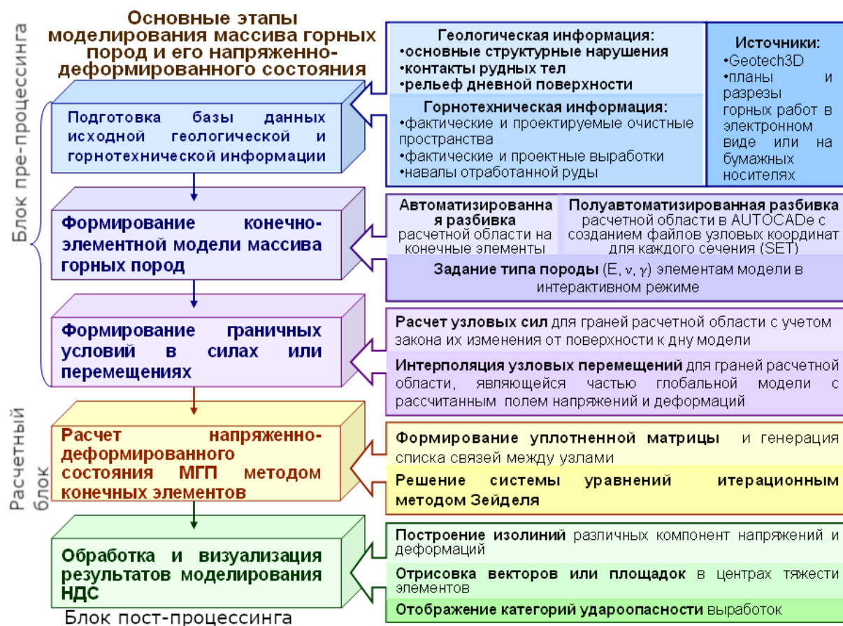
Рисунок 1.6 - Блок-схема программного комплекса SigmaGT
