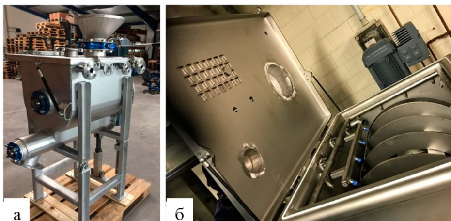
Рисунок 1.5 – Реактор «сухого» выщелачивания (а); система сопел (синие) (б)
