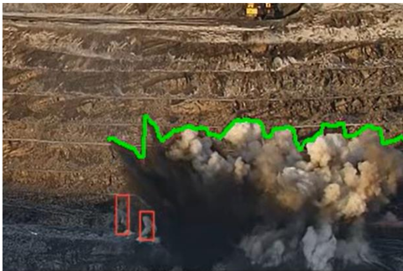
Рисунок 1 – Результат применения совокупности алгоритмов OpenCV и модели нейронной сети
