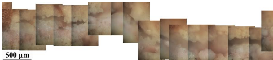
Рисунок 4 - Трещина в образце из компактированного порошка скорлупы куриных яиц, возникшая при диаметральном сжатии
