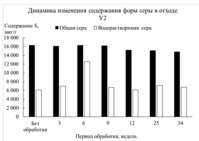
Рисунок 1 - Динамика изменения показателей: а - pH водных вытяжек для отходов У1-У3, б - содержания серы для отхода У2
