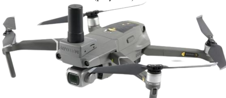
Рисунок 1 - Квадрокоптер DJI Mavic 2 Pro с ГНСС модулем
