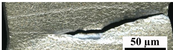
Рисунок 3 - Развитие трещины в шейке поликристаллического алюминия при растяжении
