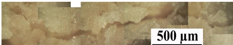
Рисунок 2 - Трещина в образце сиенита, возникшая при изгибе
