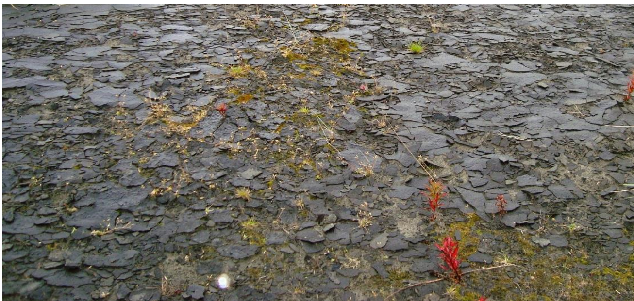
Рисунок 1.5. Результат применения анионной битумной эмульсии для пылеподавления на резервном хвостохранилище АНОФ-2
