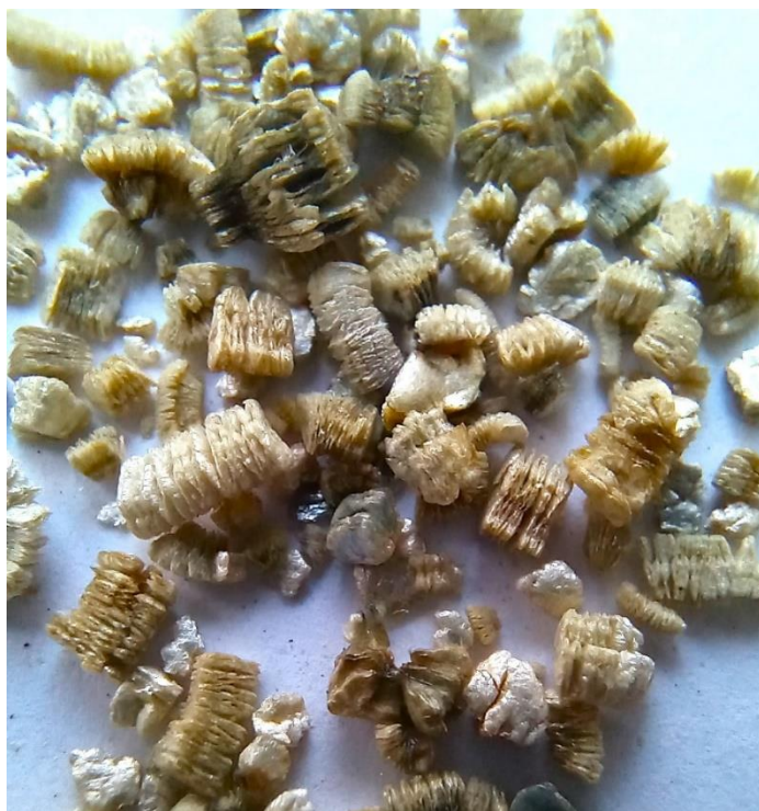
Рисунок 2.8. Вспученные гофрированные гранулы мелкофракционированного термовермикулита марки Випон-2 – "гармошки"
