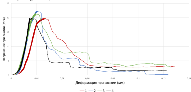
Рисунок 6 - Кривые нагружения образцов: 1 – не подверженного воздействию H_2SO_4 ; после выдержки в H_2SO_4 в течение: 2 – 30 суток; 3 – 60 суток; 4 – 90 суток
