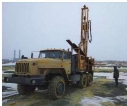
Рисунок 4. 5. Фото с места отбора проб в ходе геолого-оценочных работ с использованием буровой установки типа УРБ 2Д3 на базе автомобиля УРАЛ
