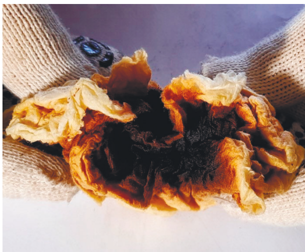
Рисунок 14 – Очаг тления образца промасленной бумаги
