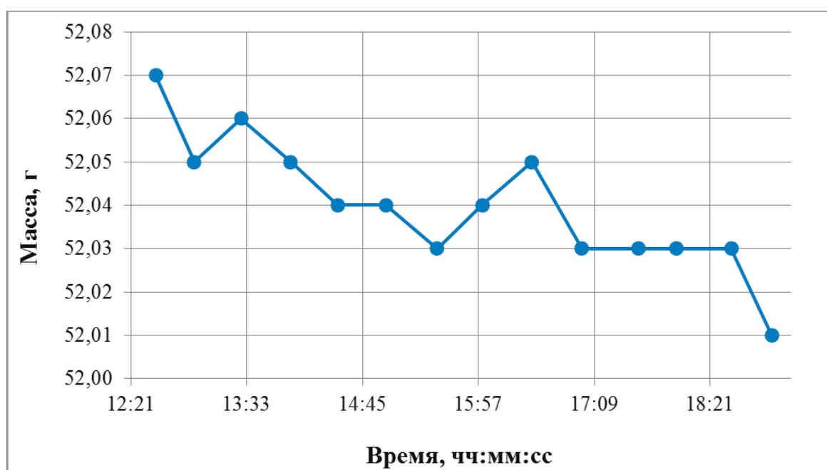
Рисунок 20 – Поведение угля III при постоянной температуре нагрева 120 °С
