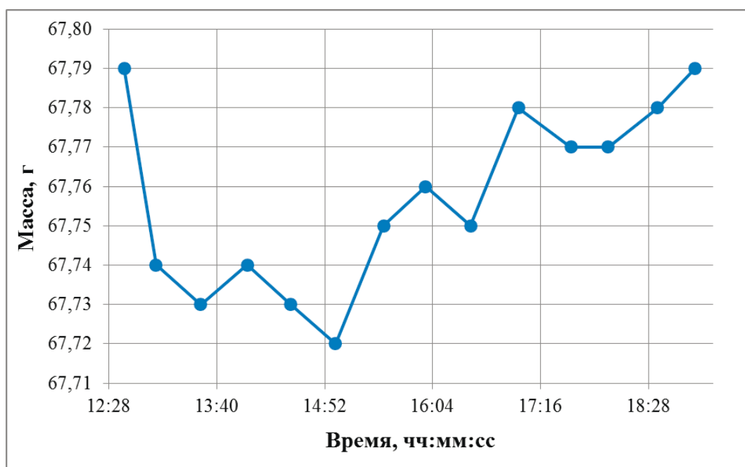
Рисунок 19 – Поведение угля I при постоянной температуре нагрева 120 °С
