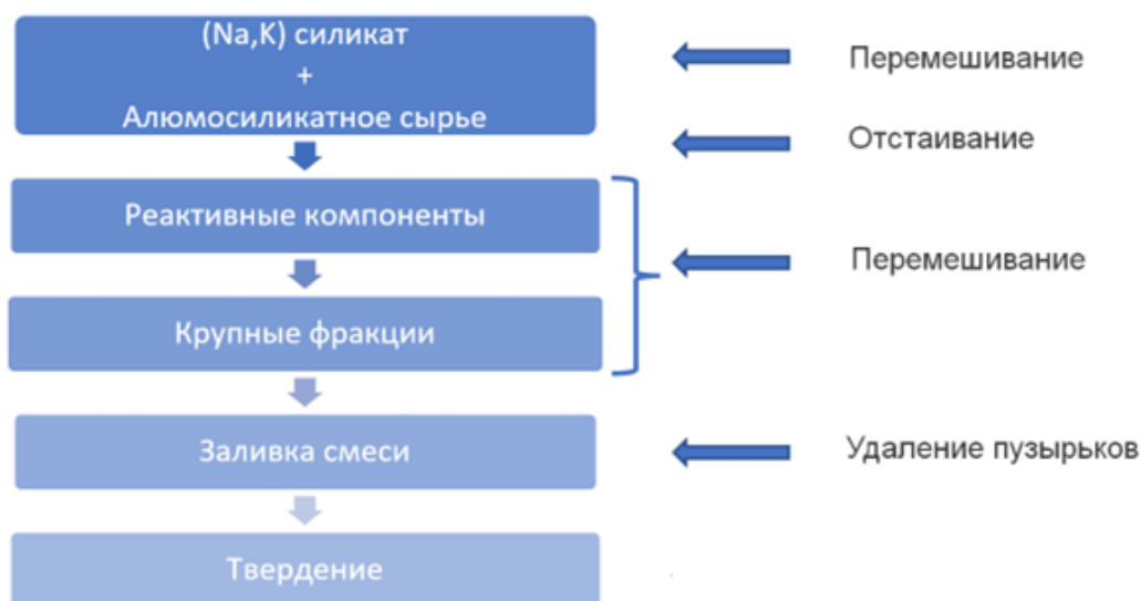
Рисунок 2.10 - Процесс приготовления геополимера
