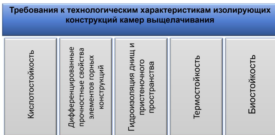
Рисунок 2.1 - Требования к свойствам искусственных массивов для реализации технологии подземного выщелачивания
