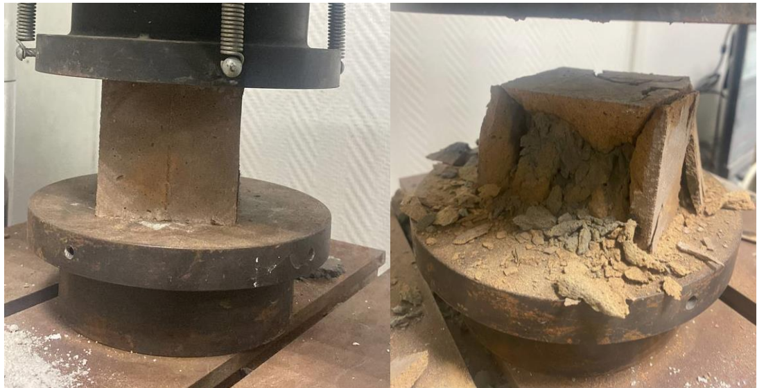
Рисунок 3.16 - Характер разрушения кубического образца при одноосном сжатии на 60 сутки твердения после обжига при температуре 600 0 С
