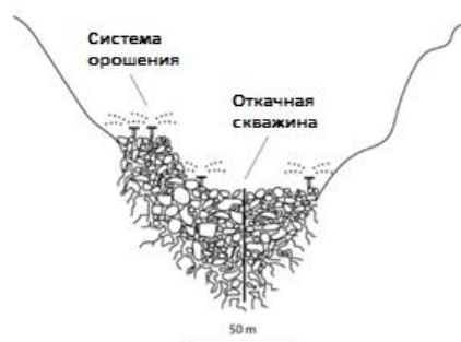
Рисунок 1.6 – Выщелачивание меди на руднике Биг Майк
