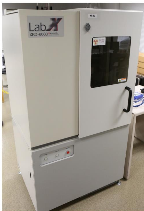
Рисунок 2.6 - Рентгеновский дифрактометр XRD 6000 («SHIMADZU») для определения фазового минерального состава медно-колчеданного золотосодержащего сырья
