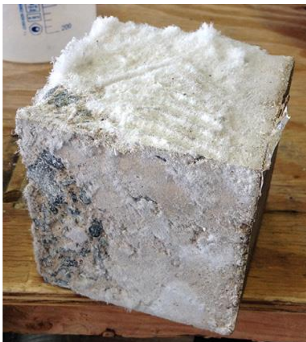
Рисунок 1.15 - Высолообразование на поверхности шлакощелочного бетона [73]
