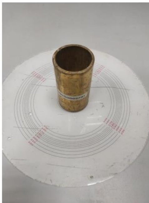
Рисунок 2.11 - Стандартный вискозиметр Суттарда для определения растекаемости смеси
