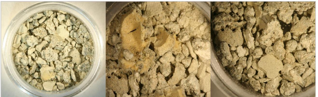
Рисунок 61 – Внешний вид осадка после осаждения железа из раствора.
