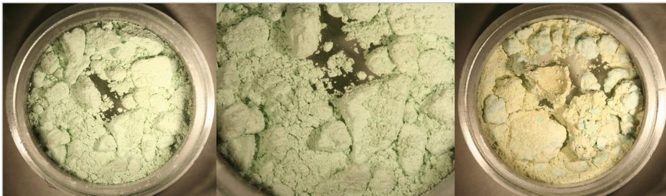
Рисунок 66. Внешний вид осадка после извлечения никеля из продуктивного раствора.
