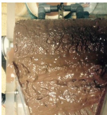
Рисунок 7 – Извлечение глинистых частиц на положительно заряженном барабане
