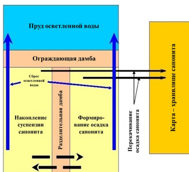
Рисунок 1.5 – Схема хвостохранилища с криогенной обработкой [25, 60]
