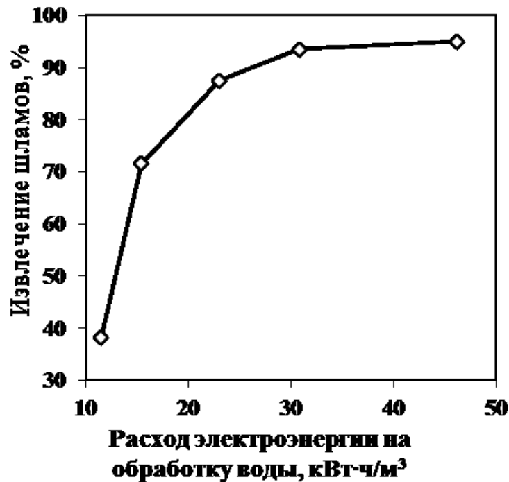
Рисунок 4.14 – Зависимость извлечения твердой фазы в сгущенный продукт (извлечение сапонитсодержащего продукта на барабане – аноде) от затрат электроэнергии на обработку 1 \text{ м}^3 воды ( U = \text{const} = 30 \text{ В} ; продолжительность обработки t_{\text{обр}} = 2,3, 3,1, 4,7, 6,2, 9,3 минут)
