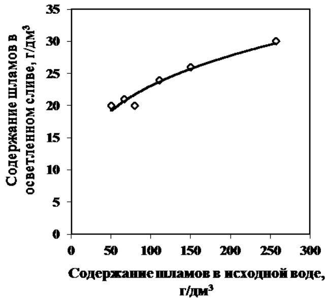
Рисунок 4.28 – Изменение содержания твердой фазы в сливе ЭХМ-0.1 в зависимости от содержания шлама в питании (производительность по сливу ЭХМ-0.1 – 40 дм 3 /ч, рабочее напряжение 30 В)
