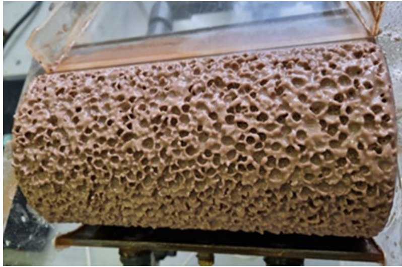
Рисунок 4.12 – Извлечение глинистых частиц на положительно заряженном барабане
