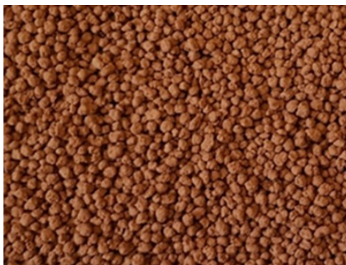
Рисунок 6.1 – Образец сорбента на основе модифицированного сапонитсодержащего продукта класса крупности -2 +1 мм
