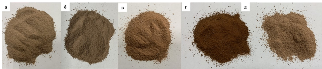
Рисунок 5.16 – Внешний вид композитов (а - исходный сапонит (Sap), б - электрохимически модифицированный сапонит (Sap эхо ), в - исходный сапонит после обжига (Sap 400 ), г - Fe-Sap 400 , д - Al-Sap 400 )
