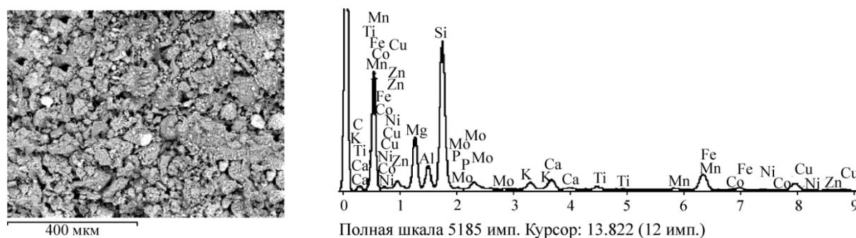
Рисунок 6.8 – РЭМ-изображение и энергодисперсионный спектр поверхности сорбента после контакта с раствором катионов Cu, Ni, Co, Sr, Mo, Zn и Mn, содержащим металлы в количествах 147-157 мг/дм 3 (суммарное содержание металлов ~ 1 г (таблица 6.2))
