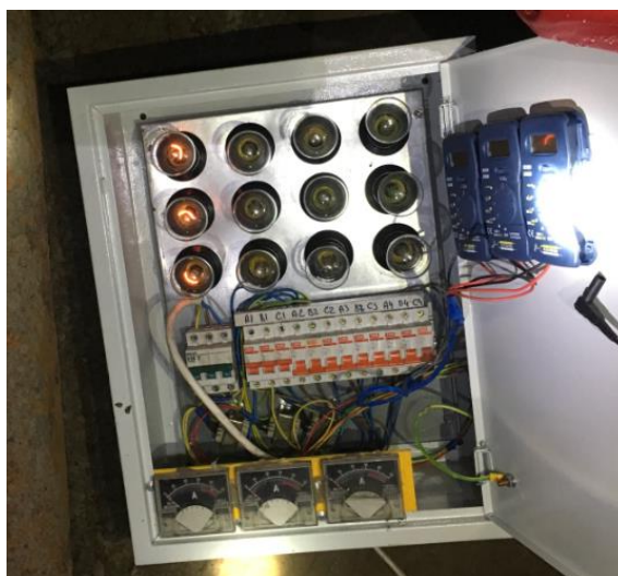
Рисунок 3.16 – Нагрузочно-измерительный стенд экспериментальной установки
