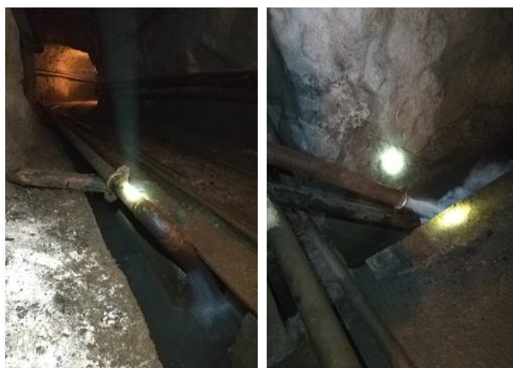
Рисунок 2.10 – Места установки испытательного оборудования, а – приемная труба скважины №2, б – приемные трубы скважин №1 (нижняя) и №3 (верхняя)
