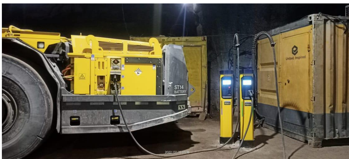
Рисунок 3.18 - Существующая зарядная станция ЭПДМ на подземных рудниках Жезказганского месторождения
