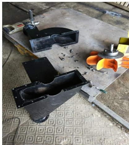
Рисунок 2.9 – Гидротурбинная установка в разборе
