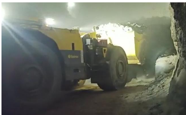
Рисунок 3.8 – Проведение хронометражных наблюдений с учетом анализа циклов работы: а - внедрение и наполнение ковша, совершаемые погрузчиком CAT 980; б - погрузка руды в автосамосвал дизельной ПДМ Sandvik Toro 0011 (LH621); в - доставка руды Электро-ПДМ ST14 Battery до автосамосвала; г - учет скоростей
