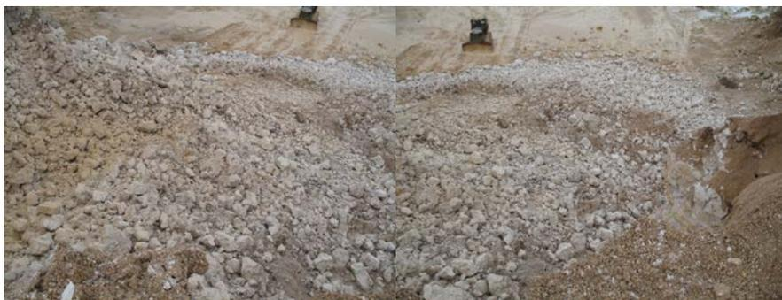
*Рисунок 6 – Опытно-промышленное взрывное дробление известняка*
