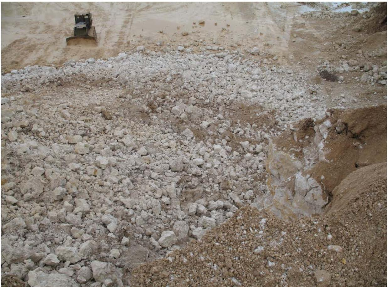
Рисунок 4.4 – Опытно-промышленное взрывное дробление известняка.
