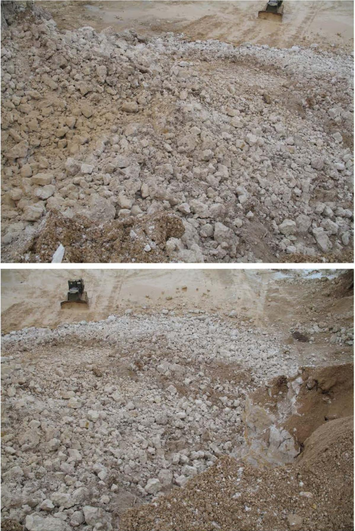
Рис. 1 Опытно-промышленное взрывное дробление известняка
