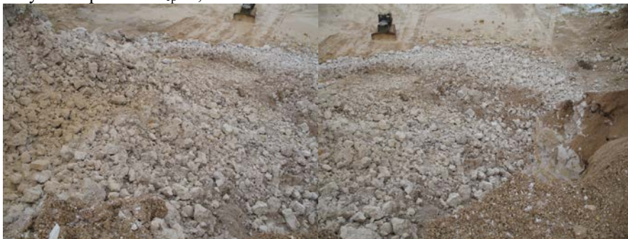
Рисунок 6 – Опытно-промышленное взрывное дробление известняка.
