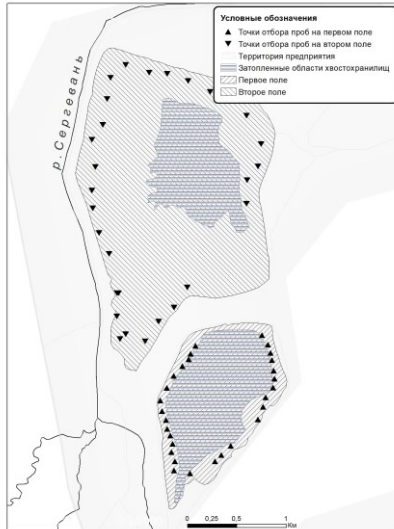
Рисунок 1. Схема отбора проб хвостов обогащения лопаритовых руд
