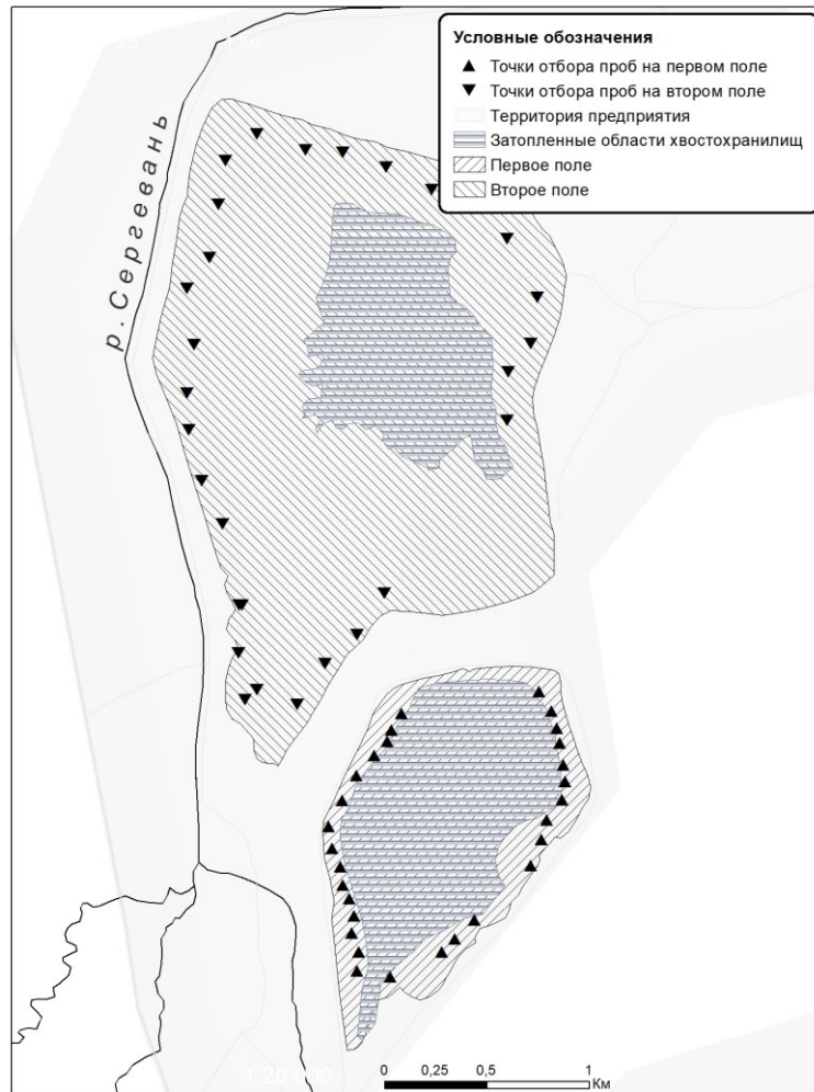
Рисунок 3.2. Схема отбора проб хвостов обогащения лопаритовых руд
