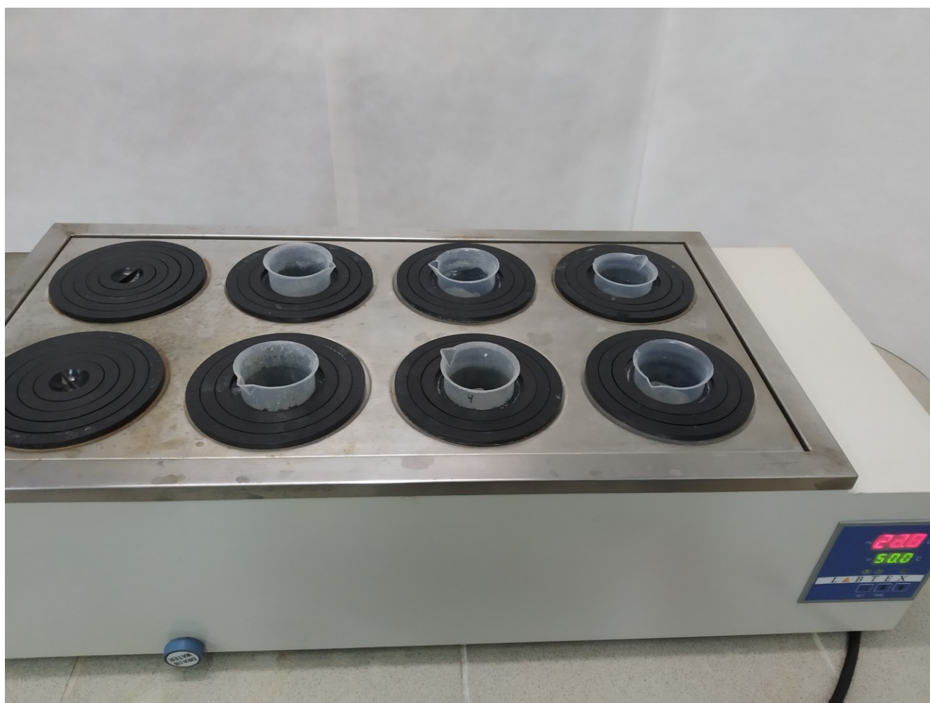
Рисунок 4.2. Водяная баня, проведение серии экспериментов в режиме увлажнение-высыхание с хвостами обогащения лопаритовых руд текущего производства
