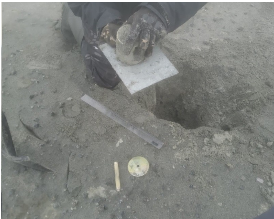
Рисунок 2.4. Отбор проб хвостов обогащения лопаритовых руд
