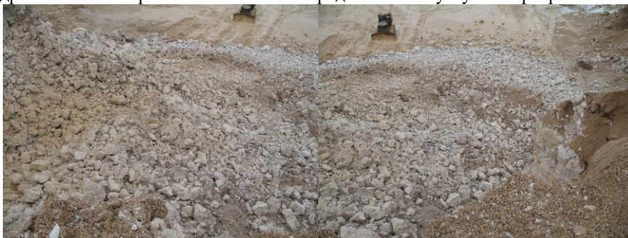
Рисунок 6 – Опытно-промышленное взрывное дробление известняка.
