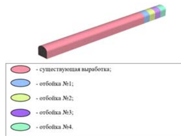
Рис. 2. Стадии проходки и закрепления выработки в расчетной модели
