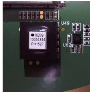
Рис. 2. Инклинометр и магнитометр на материнской плате EFT M2 GNSS
