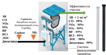
Рис. 1. Общий вид фильтрующей установки с указанием удаляемых компонентов из газового потока
