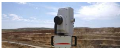
Рис. 1. Горный сканер Leica HDS 8800 191
