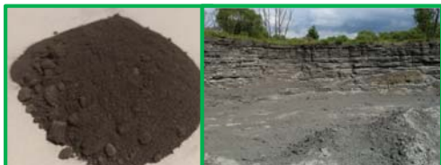
Фото 1. Образец золы-уноса и золошлаковый отвал в Тульской обл.
