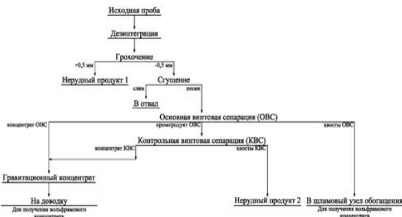
Рис. 1. Технологическая схема предварительной концентрации ценных компонентов из пробы лежалых хвостов Акшатауского ГОКа
