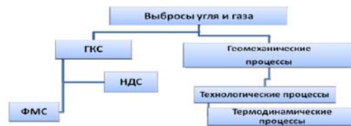
Рис. 1. Геомехано-газотермодинамическая модель формирования выбросов угля и газа на текущем уровне: а) геомеханические процессы; б) технологические процессы; в) термодинамические процессы; г) газокинетические свойства-ГКС; д) напряженно-деформированное состояние пласта-НДС; е) физико-механические свойства пласта-ФМС
