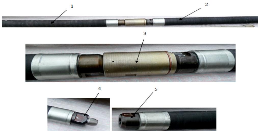
Рисунок 15 – Разрывное устройство 1,2- упруго расширяющиеся рукава, 3-межпакерный клапан, 4-наконечник запорный, 5-муфта присоединительная
