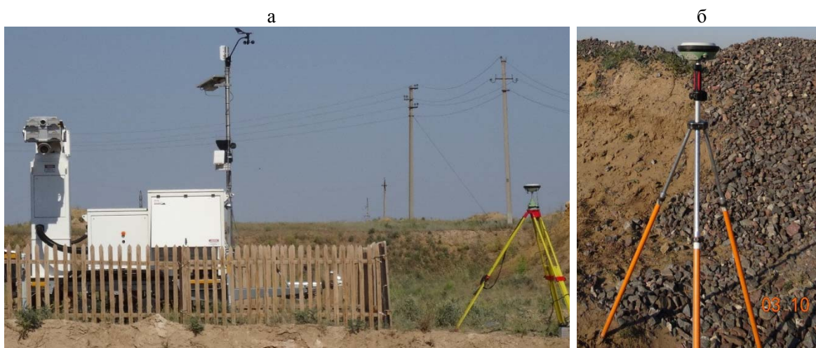
Рисунок 10 – Контроль состояния устойчивости карьерных откосов с использованием GNSS а – базовая станция LeicaGS 14, установленная на штативе; б – измерение координат опорного репера наблюдательной станции II (LeicaGS 14)
