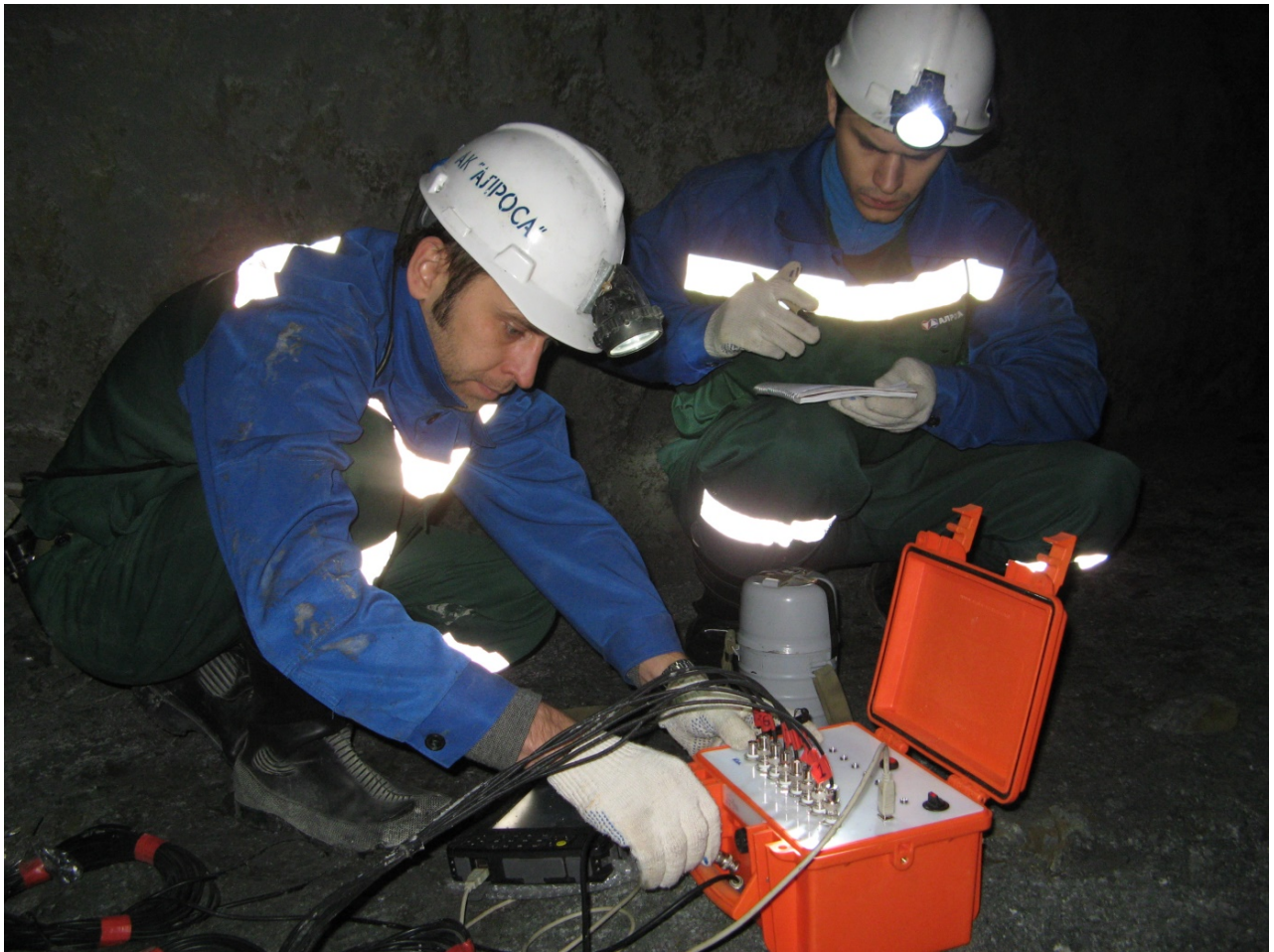
Рисунок 12. Проведение ультразвуковых работ
