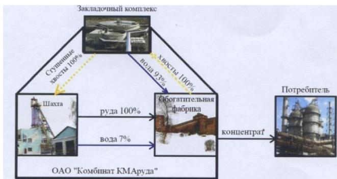
**Рис. 3. Технологическая схема движения минерально-сырьевых потоков**
