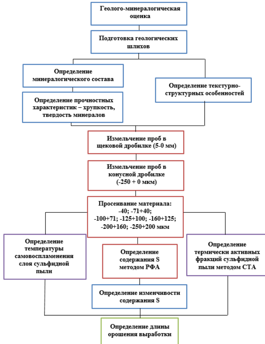
Рисунок 3.29 – Алгоритм проведения оценки склонности сульфидной пыли к взрывоопасности
