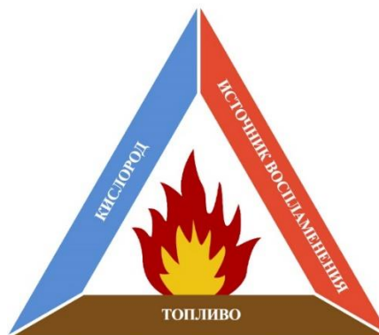
Рисунок 1.5 – Компоненты огненного треугольника
