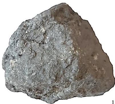
Рисунок 3.7 - Внешний вид кварц-антимонитовой руды (проба Т-1)
