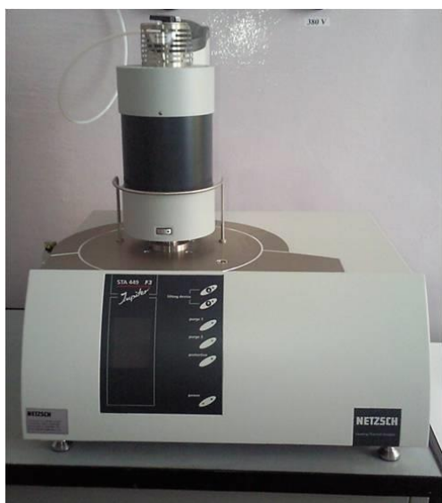
Рисунок 2.5 - Внешний вид прибора синхронного термического анализа STA 449 F3 Jupiter.
