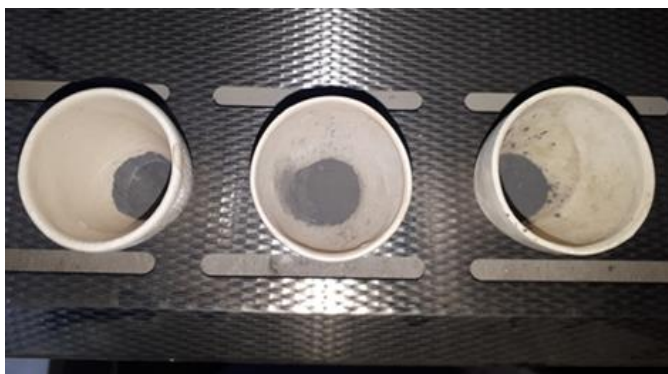
Рисунок 3.23 – Образцы кварц-антимонитовой руды: а) до нагрева в печи; б) после обжига
