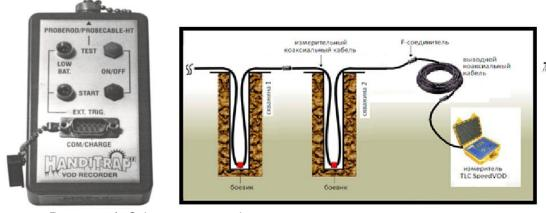
Рисунок 4. Общий вид прибора для измерения скорости детонации по длине скважины и схема установки регистрирующего кабеля в скважинах
