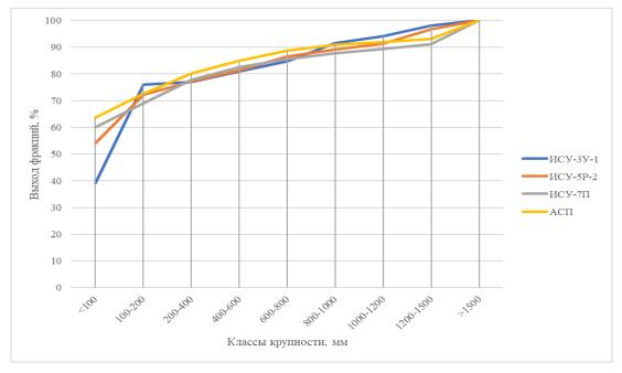
Рисунок 6. Кумулятивные кривые гранулометрического состава отбитой горной массы
