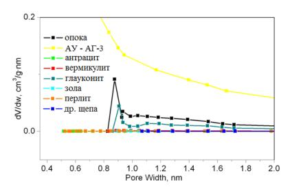
Рис 4.16 – Распределение микропор по размерам (увеличение по оси Y)
