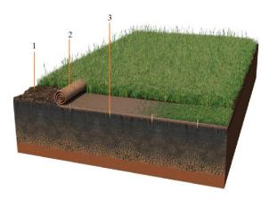
Рисунок 6.10 — Технология фиторемедиации почв с использованием биополотна с предлагаемыми травосмесями
