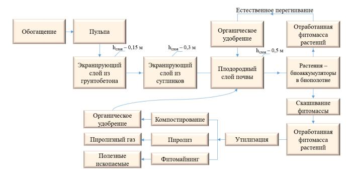
Рисунок 6.14 – Технологическая схема рекультивации хвостохранилищ
