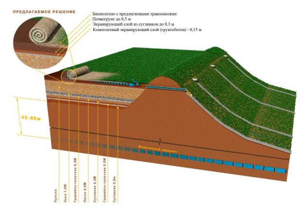
Рисунок 6.15 — Номинальная конструкция карты хвостохранилища и технологические решения
