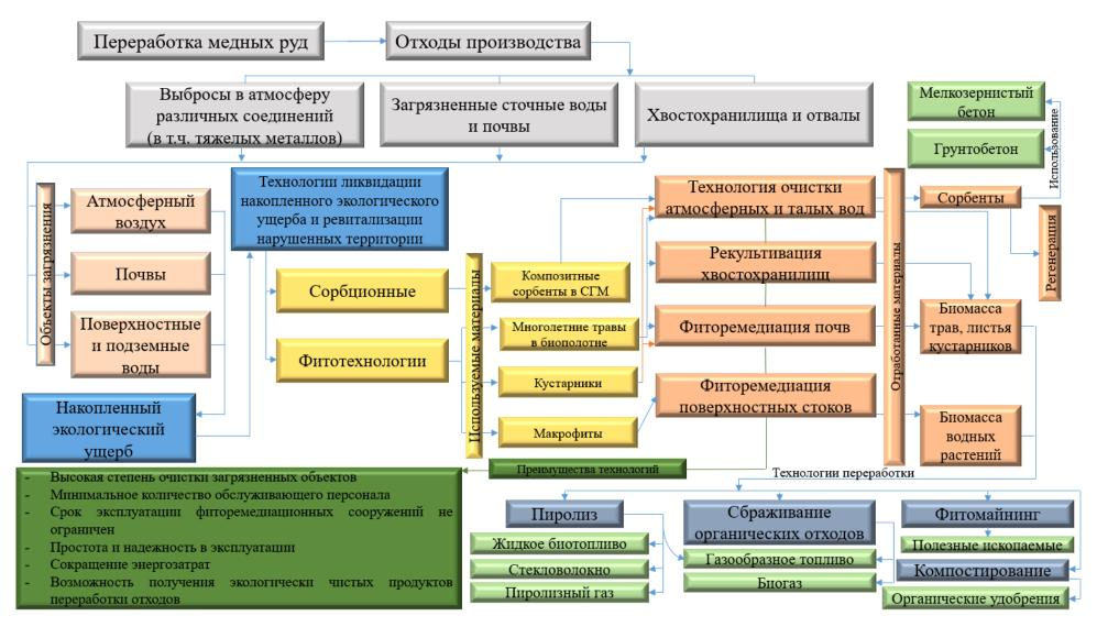
Рисунок 6.16 – Комплексная технологическая схема ликвидации накопленного ущерба
