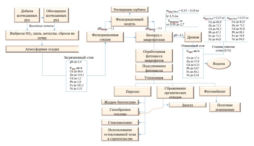
Рисунок 6.3 – Технологическая схема очистки стоков в фиторемедиационном сооружении
