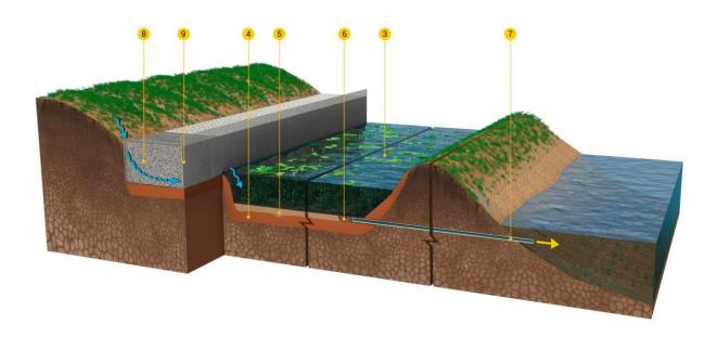
Рисунок 6.2 – Биопруд для очистки слабокислых поверхностных сточных вод, загрязненных тяжелыми металлами (Вариант 2)
