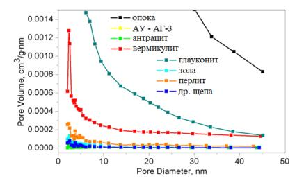
Рис 4.14 – Распределение мезопор по размерам (увеличение по оси Y)
