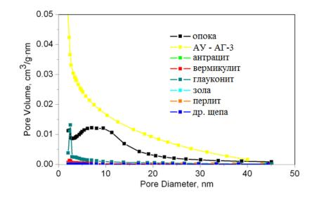
Рис 4.13 – Распределение мезопор по размерам
