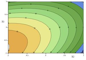
Рисунок 2.6 – Зависимость прочности композитов в возрасте 7 суток
