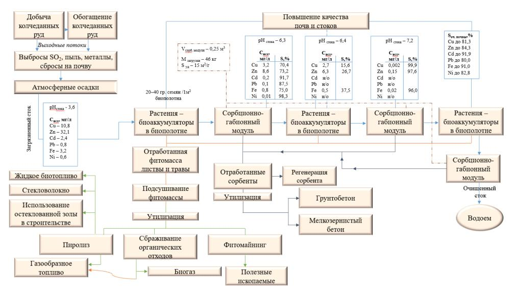
Рисунок 6.12 – Технологическая схема комплексной ремедиации почв и атмосферных стоков от тяжелых металлов
