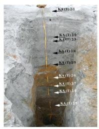
Рисунок 3.21 — Вертикальный разрез через зону окисления, зону цементации хвостохранилища «Новое»
