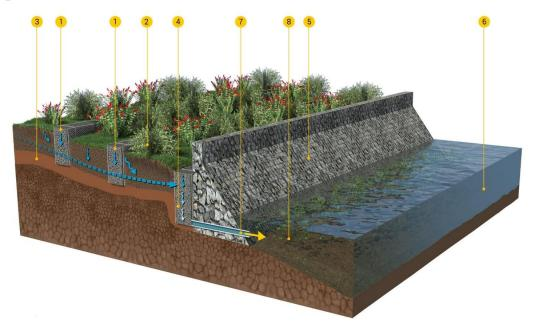
Рисунок 6.7 – Система очистки поверхностных сточных вод и загрязненных почв от тяжелых металлов
