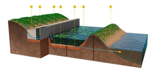
Рисунок 6.1 – Биопруд для очистки сильнокислых поверхностных сточных вод от тяжелых металлов (Вариант 1)
