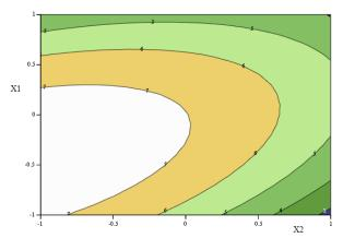
Рисунок 2.5 – Зависимость прочности композитов в возрасте 3 суток
