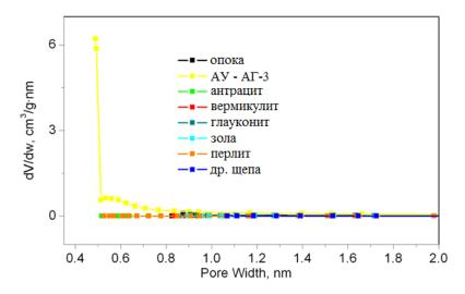
Рис 4.15 — Распределение микропор по размерам
