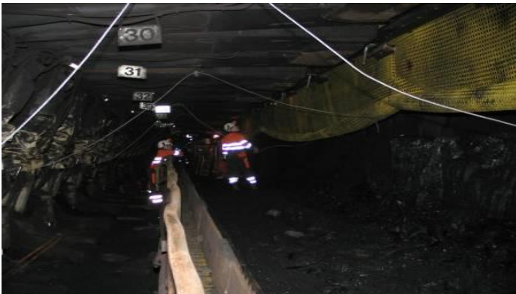
Рисунок 4.4. Полимерная сетка подтянута ручными лебедками.
