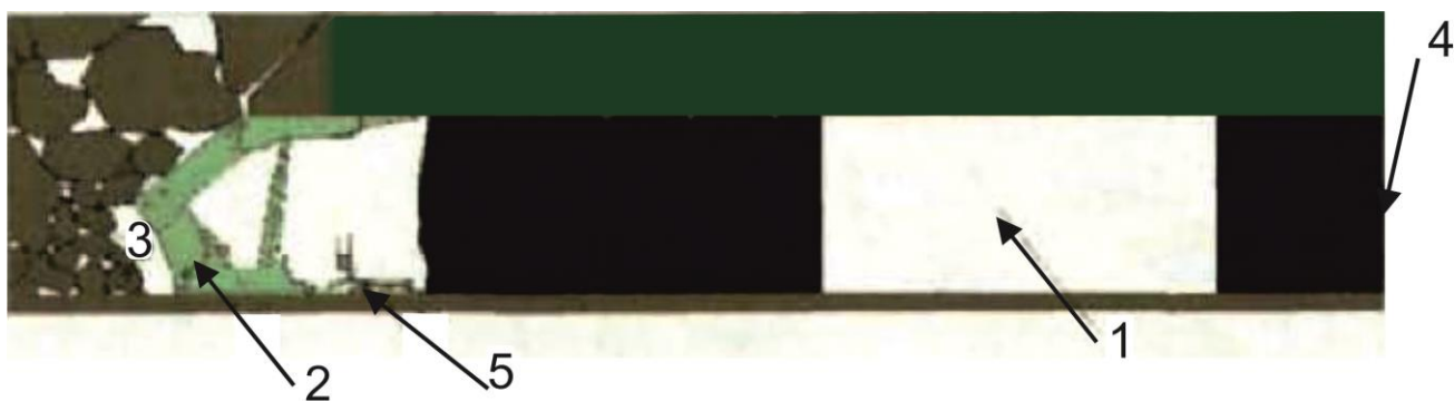
Рисунок 1.2 Подход механизированного комплекса к заблаговременно подготовленной демонтажной камере: 1 – ДК; 2 – механизированная крепь; 3 – обрушенные породы; 4 – угольный пласт; 5 – скребковый лавный конвейер
