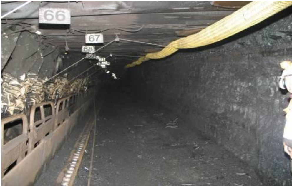
Рисунок 4.5. Вид забоя перед 1 –м циклом формирования демонтажной камеры.
