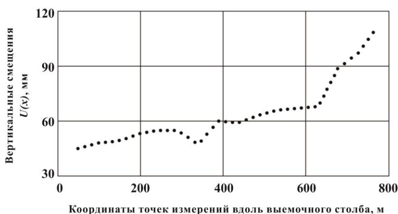
Рисунок 2.2 Зависимость изменений вертикальных смещений кровли от координаты точки измерений вдоль выемочного столба U(x) (очистной забой № 1390)
