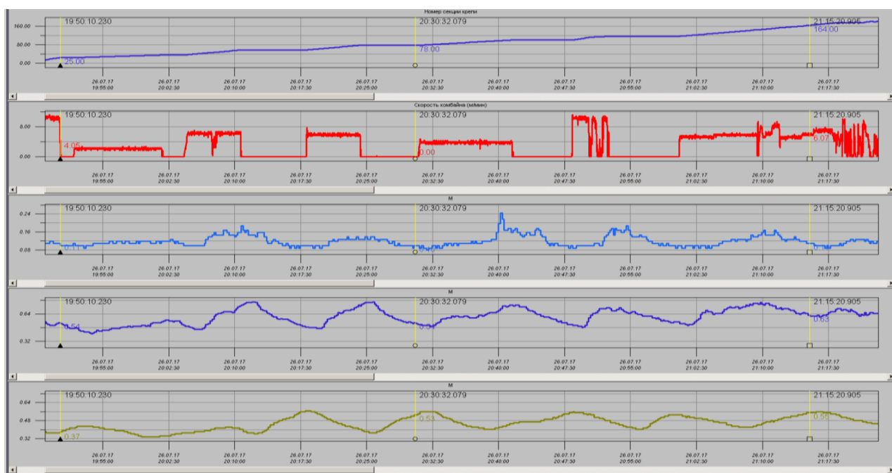
Рисунок 3. Параметры работы выемочного комбайна и показания датчиков метана за период шахтных экспериментов
