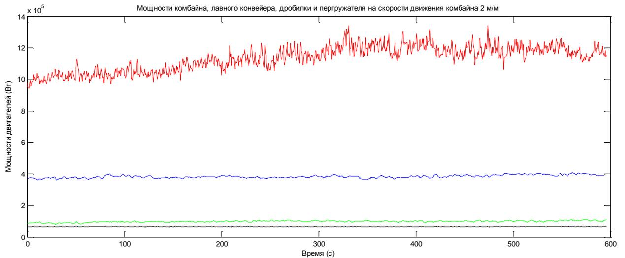
Рисунок 3.11. Текущие мощности приводов выемочного комбайна, лавного конвейера, дробилки и перегружателя при скорости подачи выемочного комбайна 2,2 м/мин
