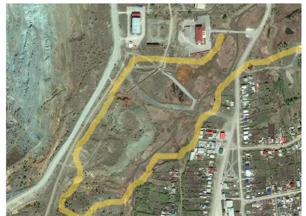
Рисунок 9 – Область 4 - наносы иловой фракции возле реки Карагайлы в месте сброса в неё рудничных вод
