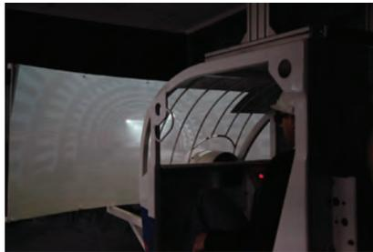
**Рис. 2. Виртуальный тренажер машиниста дизель-гидравлического локомотива**
