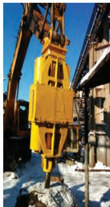
*Рис. 1. Опытный образец электромагнитного молота, установленный на колесном экскаваторе марки HYUNDAI 210*
