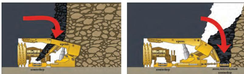
**Рис. 1. Существующие средства механизации с выпуском подкровельной толщи**
