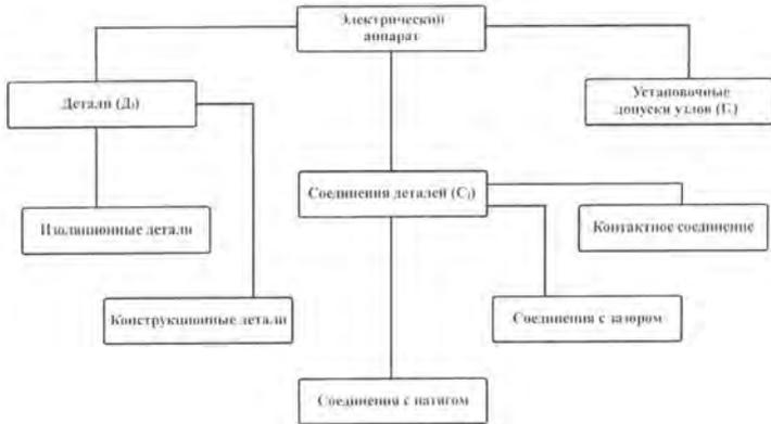
**Рис. 1. Общая схема классификации элементов электрического аппарата**
