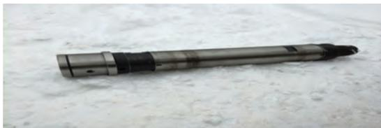
*Рис. 1. Пневмударник П165 для геологоразведки*
