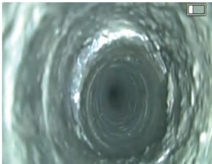
**Рис. 4. Зона расслоения пород кровли на глубине от 4,7 м до 4,8 м**
