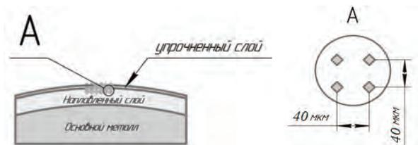
**Рис. 3. Схема измерения микротвердости**
