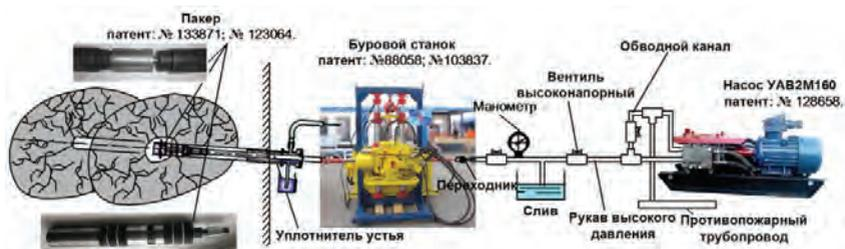
**Рис. 7. Технологическая схема интенсификации дегазации метана поинтервальной гидроразрывом пласта через дегазационную скважину**
