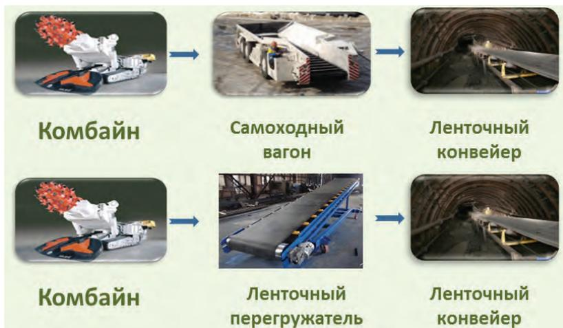
**Рис. 1. Основные варианты технологических схем в подготовительных забоях**
