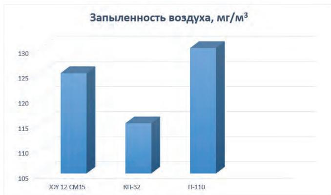
**Рис. 1. Запыленность воздуха на рабочем месте машиниста проходческого комбайна при проведении подготовительных выработок проходческими комбайнами по пласту**
