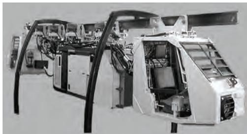
***Рис. 1. Подвесной дизель-гидравлический локомотив LSP 70.DO фирмы Ferrit***
