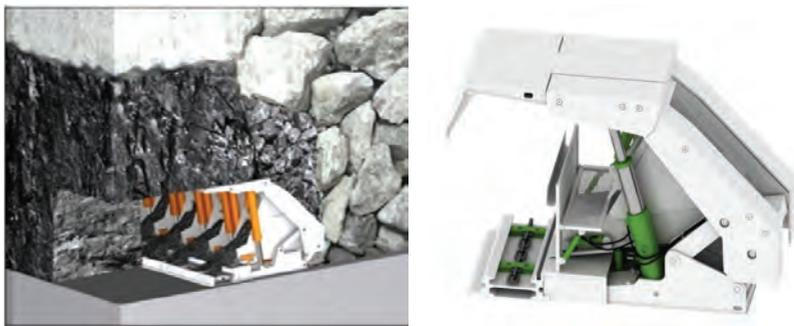
*Рис. 2. Секции механизированной крепи с регулируемым выпуском угля подкровельной толщи на забойный конвейер*
