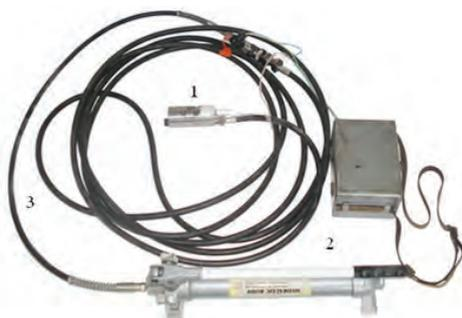
**Рис. 2. Устройство «Прочностномер ПШ-1»**
