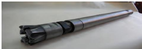
**Рис. 3. Опытный образец пневмоударника ПНБ76 с коронкой КНБ76**
