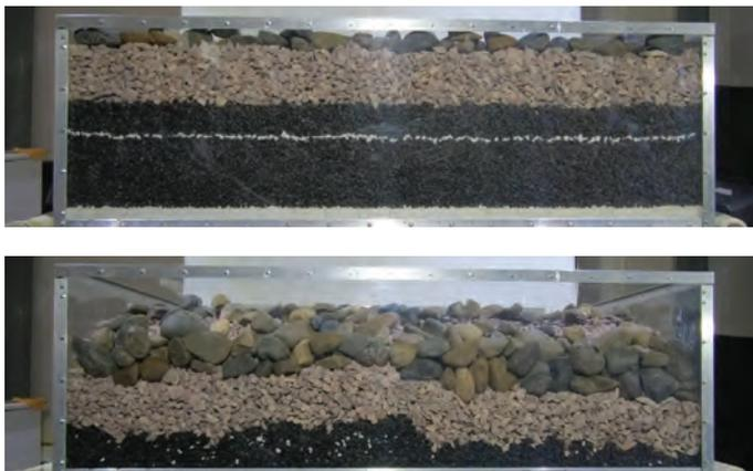
**Рис. 8. Вид сзади лабораторной установки: показаны начальная (сверху) и конечная (снизу) стадии первого выпуска, в левой части установки исследовался индивидуальный режим выпуска, в правой – волновой**
