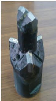
**Рис. 4. Коронка с опережающим лезвием**
