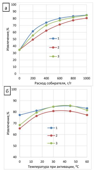
Рисунок 5. Зависимости извлечения алмазов от расхода собирателей (a) и от температуры собирателя при активации (б): 1 — флотский мазут; 2 — водонефтяная эмульсия рудника «Интернациональный» (ВНЭ-10); 3 — активированная ВНЭ-10.
