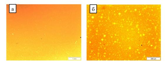
Рисунок 4 - Нефтешламы рудника «Интернациональный» после обработки аппаратом ВЭМА-0,3 в течение 3 минут: а - тонкодиспергированные микрокапли водной фазы; б — тонкодиспергированные шламовые зерна и микрокапли водной фазы
