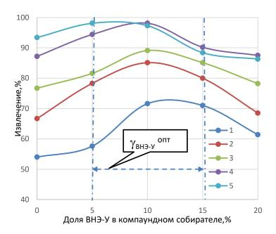
Рисунок 8. - Зависимость извлечения алмазов в концентрат от доли модифицированной водонефтяной эмульсии ВНЭ У в компаундном собирателе  $(\gamma_{\text{ВНЭ-У}})$  при его расходах , г/т: 1-190; 2-380; 3-570; 4-760; 5-950
