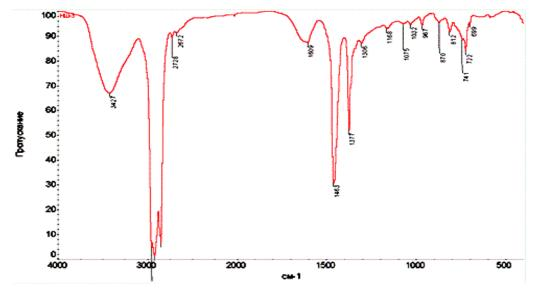
Рисунок 1 - ИК-спектр органической фракции водонефтяной эмульсии рудника «Интернациональный»
