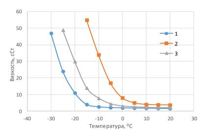
Рисунок 2 - Зависимости кинематической вязкости водонефтяной эмульсии рудников «Интернациональный» (1), «Удачный» (2) и мазута флотского  $\Phi$ -5 (3) от температуры
