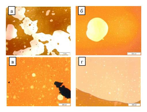
Рисунок 3 — Изображения тонкого слоя исходной водонефтяной эмульсии рудника «Интернациональный»: а — водные линзы в тяжелой нефтяной фракции; б — крупная капля водной фазы в средней нефтяной фракции; в — капли водной фазы, зерна минеральных солей и сгусток асфальтена (черного цвета) в масляной фазе; г — капли воды и минеральные соли в двух не смешивающихся органических фазах
