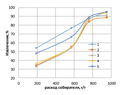
Рисунок 6. - Зависимости извлечения алмазов в концентрат от расхода собирателя при использовании: 1 —мазута флотского  $\Phi$ -5; 2 — водонефтяной эмульсии рудника «Интернациональный» (ВНЭ-10) без активации; 3 — ВНЭ-10 после 1 мин. активации; 4 — ВНЭ-10 после 2 мин. активации; 5 — ВНЭ-10 после 3 мин. активации
