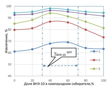
Рисунок 7. - Зависимость извлечения алмазов в концентрат от доли модифицированной водонефтяной эмульсии ВНЭ-10 в компаундном собирателе  $(\gamma_{\text{ВНЭ-10}})$  при его расходах, г/т: 1-125; 2-325; 3-650; 4-875; 5-1050.
