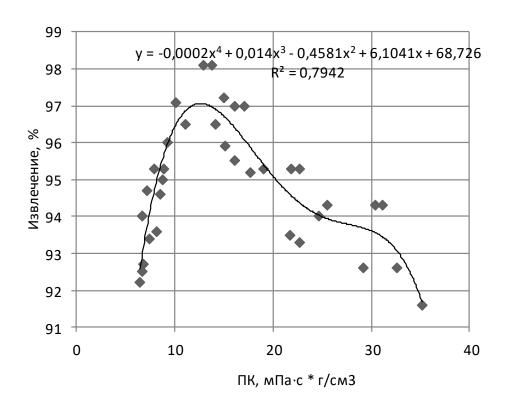
Рисунок 9. - Зависимость извлечения алмазов от показателя конденсированности (ПК) компаундного собирателя на основе смеси модифицированной водонефтяной эмульсии ВНЭ-10 и мазута флотского Ф-5
