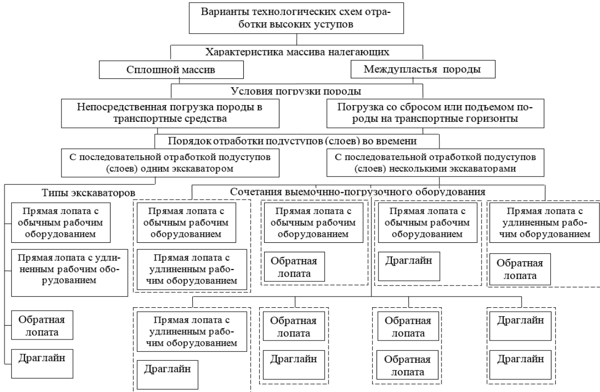
Рисунок 2 – Систематизация технологических схем обработки высокого уступа
