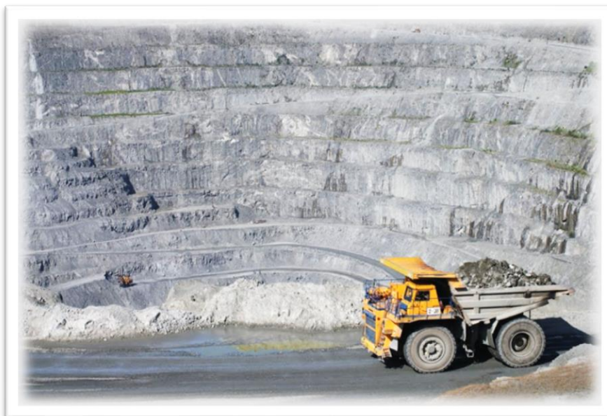
Рисунок 3.18 – Использование беспилотного автосамосвала в условиях освоения запасов глубоких горизонтов карьера
