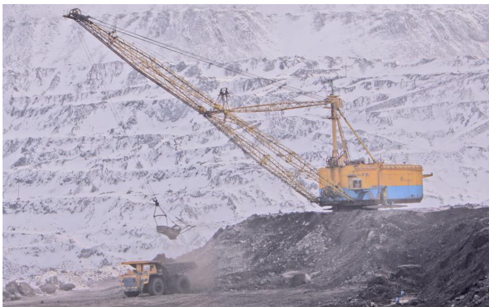
Рисунок 3.15 – Погрузка породы драглайном ЭШ-13.50 № 28 в автосамосвал БелАЗ-75306, расположенный ниже уровня установки экскаватора, на разрезе «Краснобродский» (Краснобродское поле)
