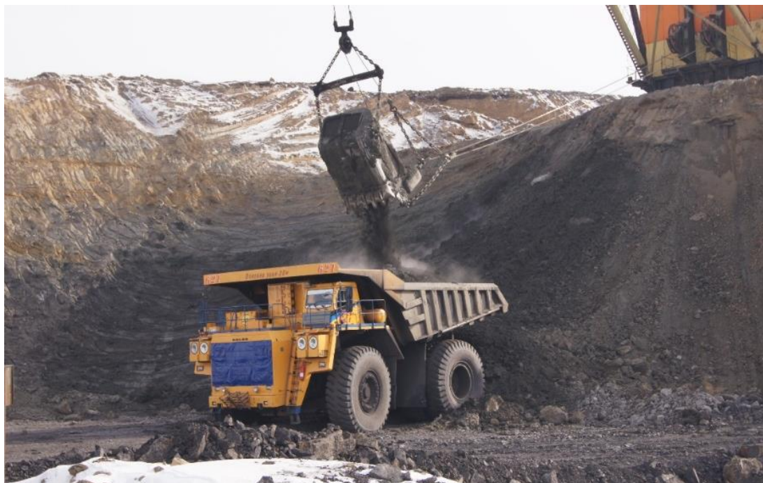
Рисунок 3.14 – Погрузка породы драглайном ЭШ-11.70 № 58 в автосамосвал БелАЗ-75306, расположенный ниже уровня установки экскаватора на разрезе «Краснобродский» (Новосергиевское поле).
