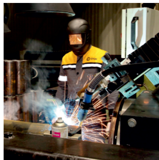
Автоматизированный сварочный пост
