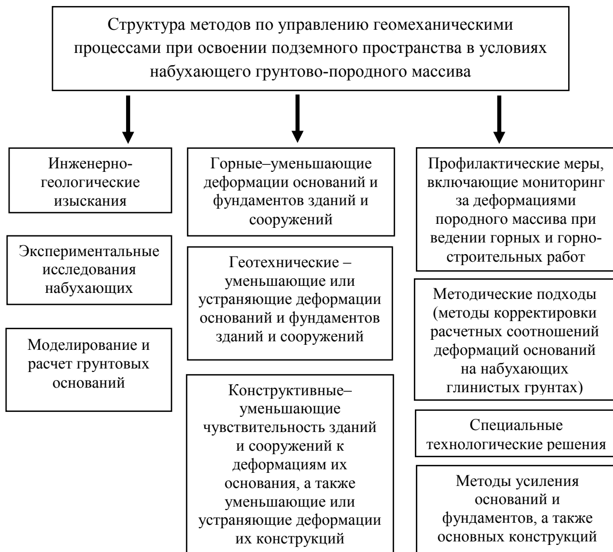
Рис. 5.10. Структура методов по управлению геомеханическими процессами при освоении подземного пространства в условиях набухающего грунтового-порodного массива.
