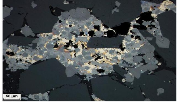
Рисунок 2.6- Сложный сросток пирита с включениями халькопирита, борнита, каймой магнетита, включениями ферритов, стекла и халькозина.
