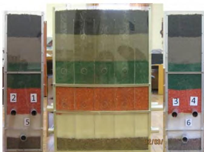
**Рис.1. Общий вид физической модели этажного торцевого выпуска**
